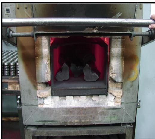
Slika 4.1.2. Zagrijavanje polovica kalupa u specijalnoj peći
