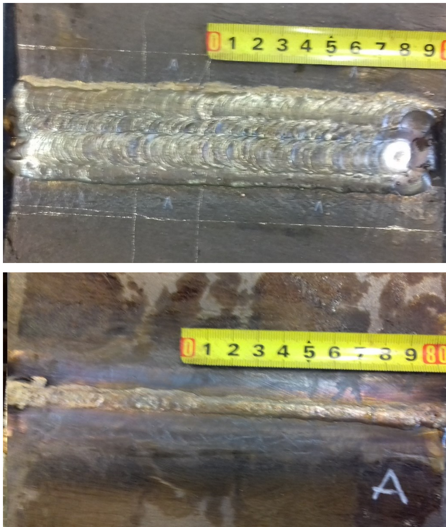
Slika 23. Lice i korijen zavara uzorka A
