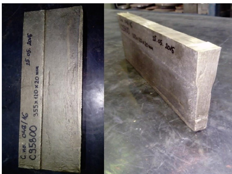
Slika 12. Osnovni materijal – odljevak CuAl10Fe5Ni5
