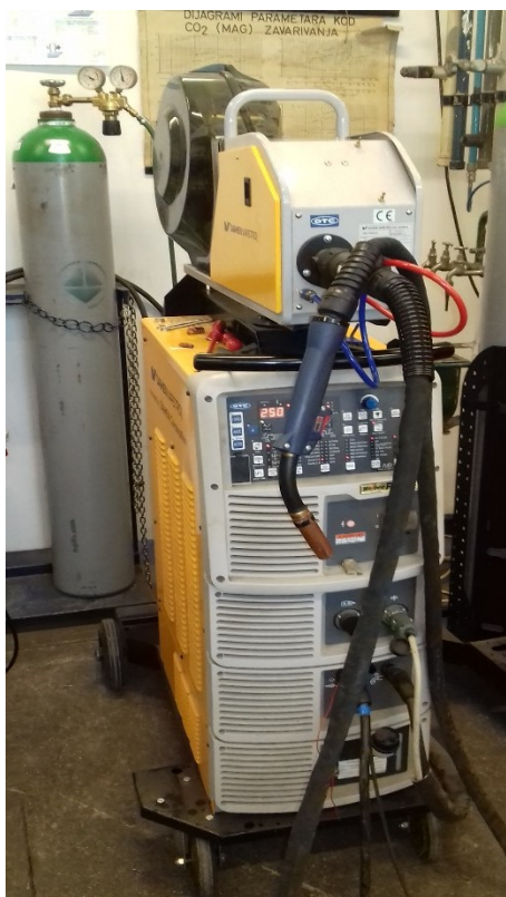
Slika 20. Izvor struje za zavarivanje VARSTROJ Welbee 500L
