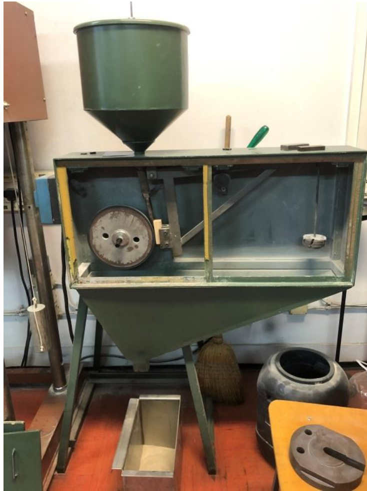
Slika 4.1 Uređaj za ispitivanje abrazijskog trošenja „Suhi pijesak – gumeni kotač“
