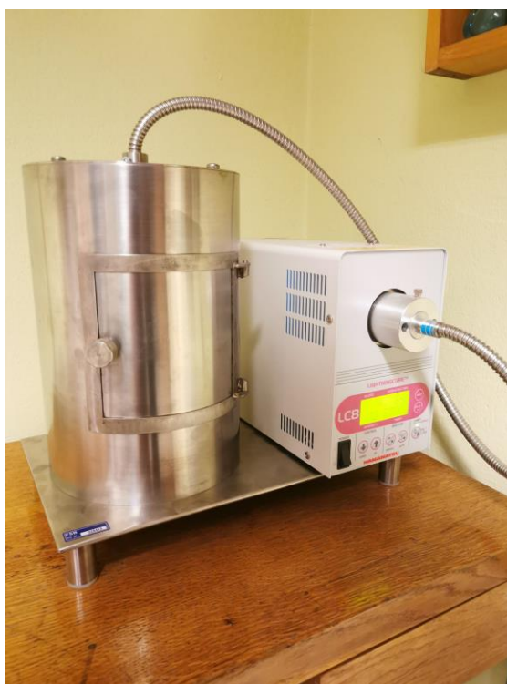
Slika 11. Uređaj Hamamatsu UV Spot Light LC8 s točkastim izvorom ultraljubičastog spektra model 02-A
