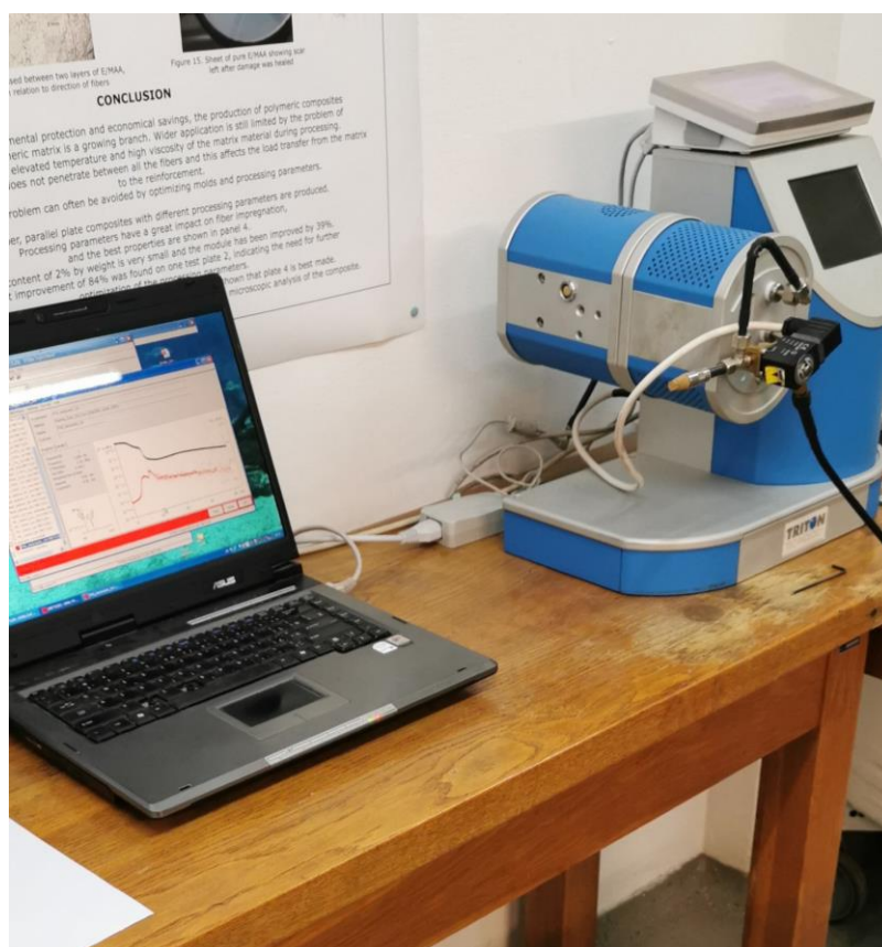
Slika 16. Uređaj za dinamičko-mehaničku analizu Triton Technology spojen na računalo s programskim paketom
