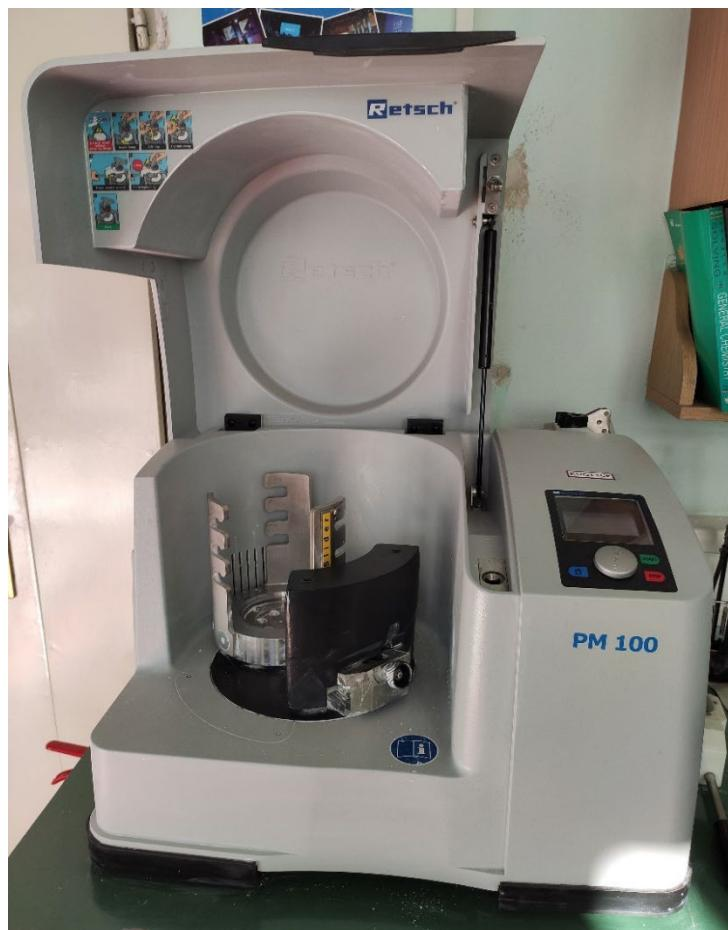
Slika 40. Planetarni kuglični mlin
