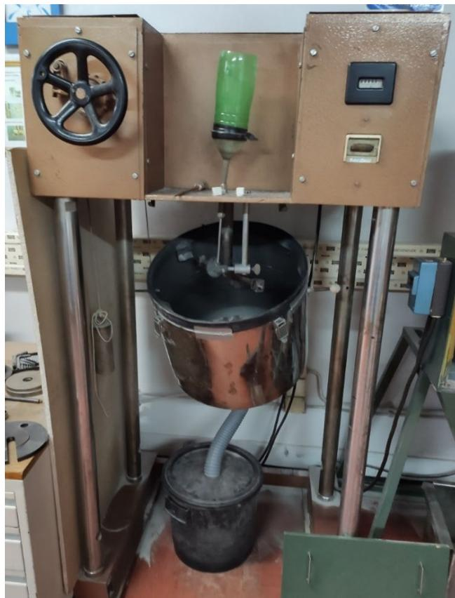
Slika 45. Uredaj za ispitivanje otpornosti na eroziju česticama
