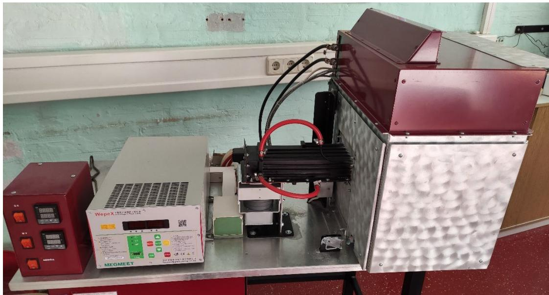
Slika 42. Peć za hibridno mikrovalno sinteriranje
