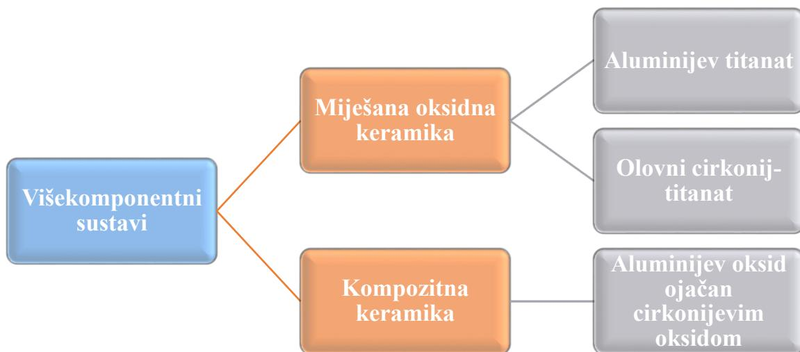
Slika 4. Shematski prikaz predstavnika višekomponentnih sustava [1]
