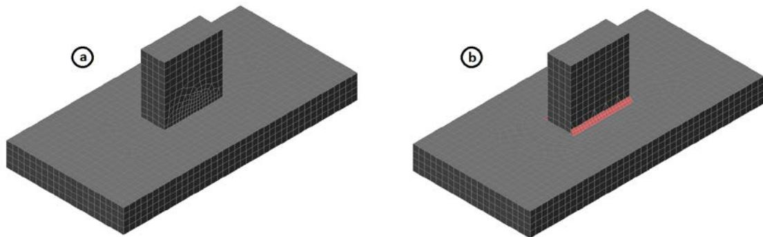
Slika 33. Prikaz geometrije i finalne mreže konačnih elemenata modela zavarenih ploča:
