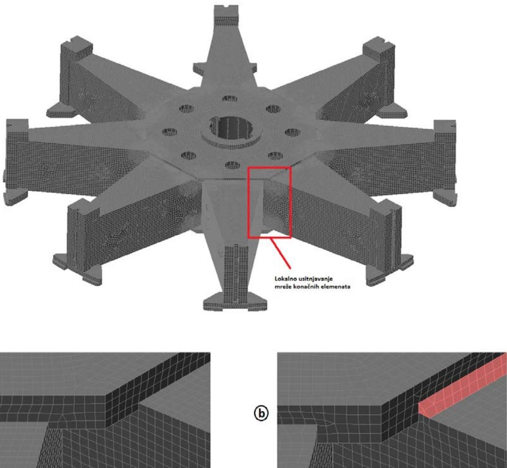
Slika 59. Prikaz geometrije i finalne mreže konačnih elemenata modela zvijezde rotora hidrogeneratora: a) model bez zavara b) model s zavarom
