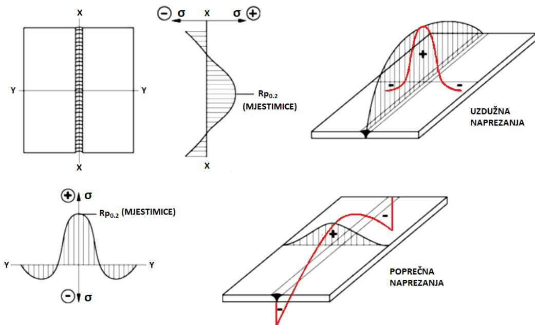
Slika 20. Uobičajena raspodjela zaostalih naprezanja u zavarenom spoju [19]
