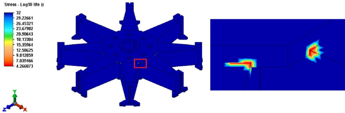
Slika 64. Prikaz mesta iniciranja i propagacije pukotine za model zvijezde rotora hidrogeneratora (bez modeliranog zavara)
