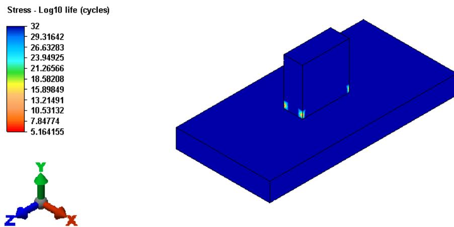
Slika 38. Prikaz mesta iniciranja i propagacije pukotine za model zavarenih ploča (bez modeliranog zavara)
