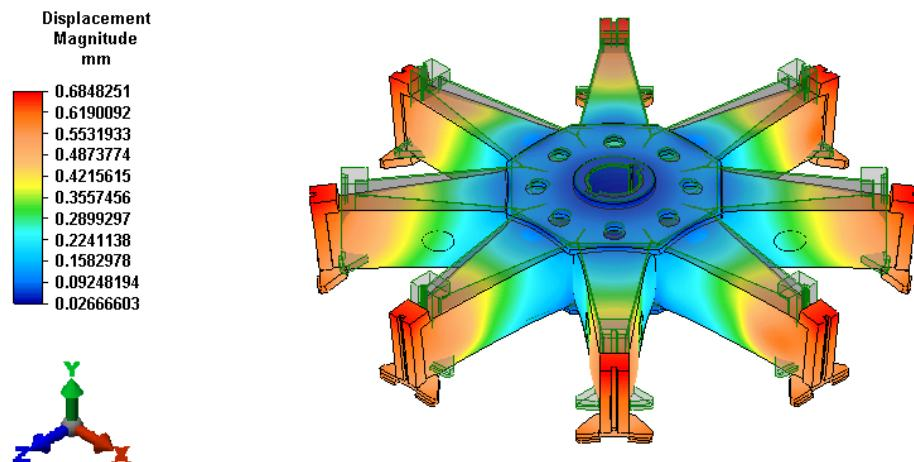
Slika 62. Raspodjela pomaka [mm] i deformirani oblik modela zvijezde rotora hidrogeneratora (bez modeliranog zavara) za slučaj teoretskog pobjega
