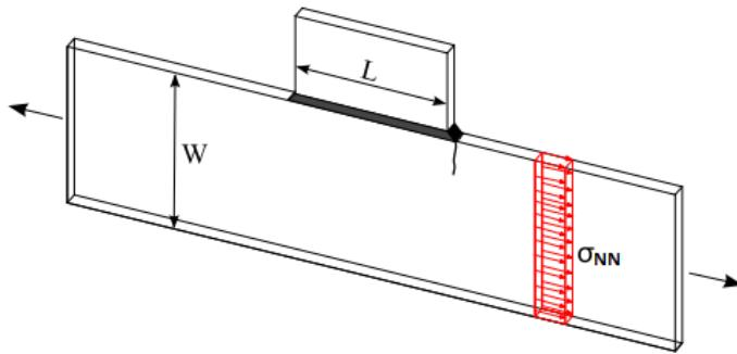
Slika 21. Odabir relevantnog naprezanja kod pristupa nominalnog naprezanja [25]
