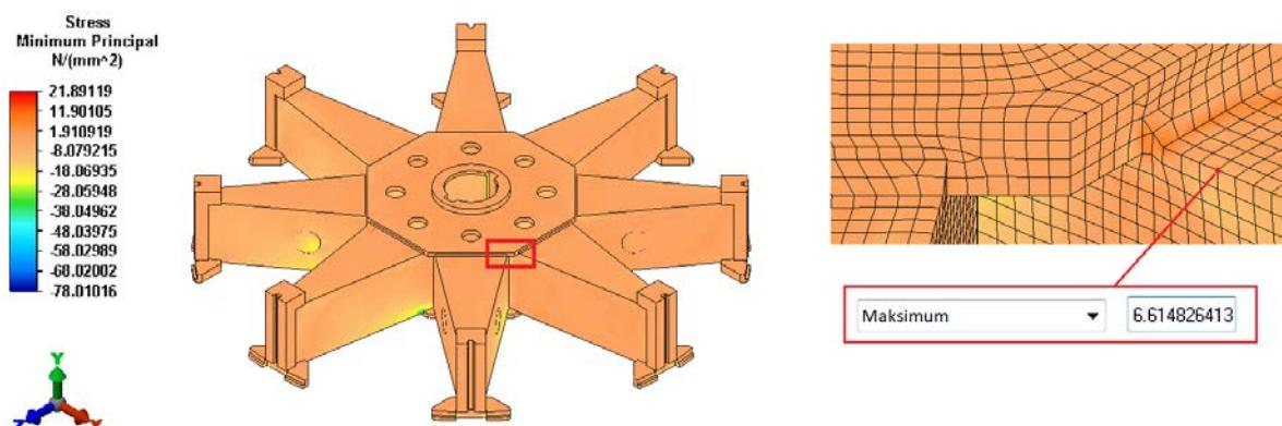
Slika 86. Raspodjela minimalnog glavnog naprezanja [ $N/mm^2$ ] za pristup nominalnog naprezanja za slučaj nominalnog rada (model zvijezde rotora hidrogeneratora s modeliranim zavarom)
