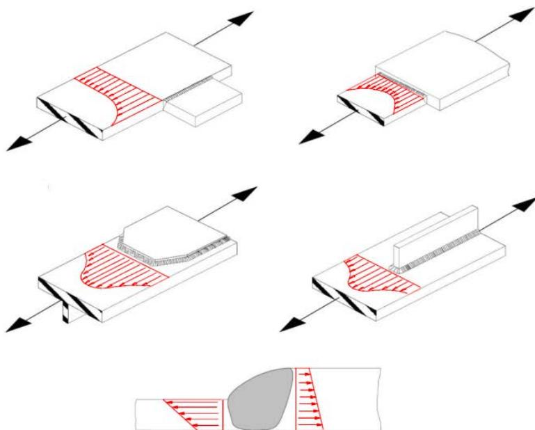
Slika 15. Prikaz koncentracije naprezanja kod zavarenih konstrukcijskih elemenata [15]
