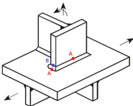
Slika 23. Tipovi žarišta kod zavarenih konstrukcija [26]
