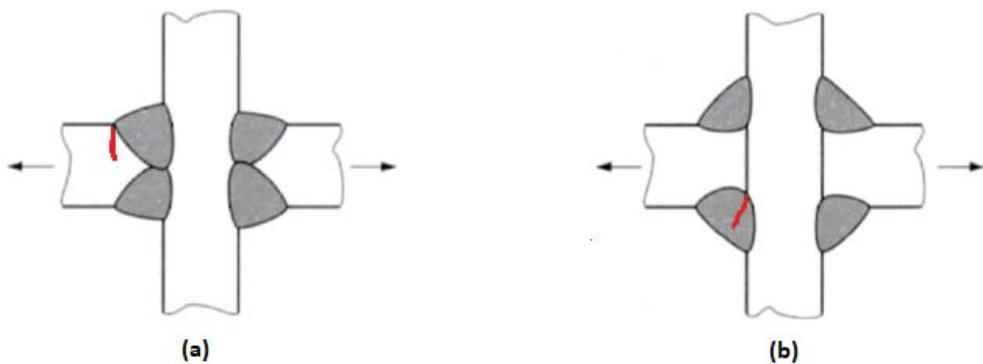
Slika 19. Prikaz mesta nastanka pukotine kod kutnog zavara (zavar prenosi opterećenje) [18]
