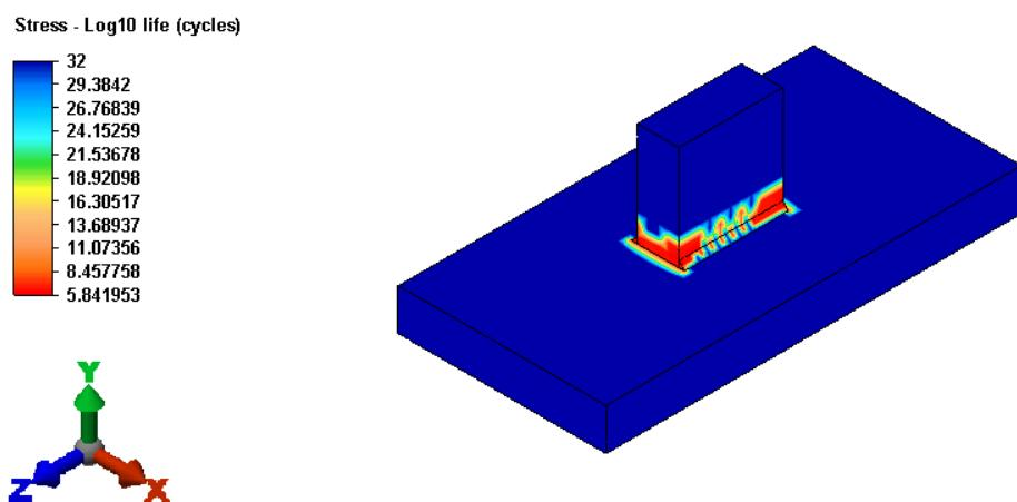
Slika 39. Prikaz mesta iniciranja i propagacije pukotine za model zavarenih ploča (s modeliranim zavarom)
