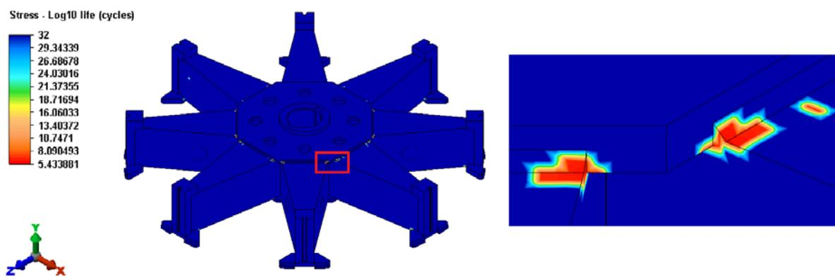
Slika 65. Prikaz mesta iniciranja i propagacije pukotine za model zvijezde rotora hidrogeneratora (s modeliranim zavarom)
