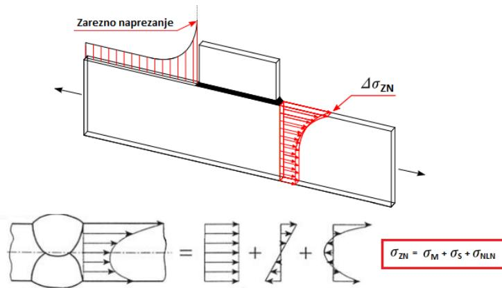
Slika 24. Odabir relevantnog naprezanja kod pristupa zareznog naprezanja [25]
