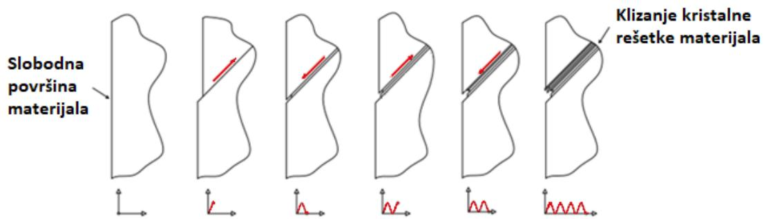
Slika 2. Mehanizam iniciranja pukotine klizanjem rešetke [6]
