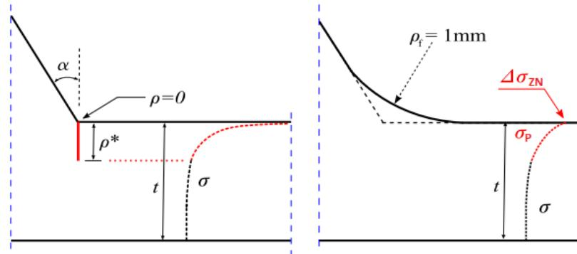
Slika 25. Prikaz fiktivnog kružnog zareza polumjera 1mm [25]
