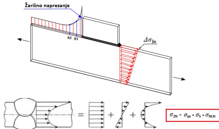
Slika 22. Odabir relevantnog naprezanja kod pristupa žarišnog naprezanja [26]
