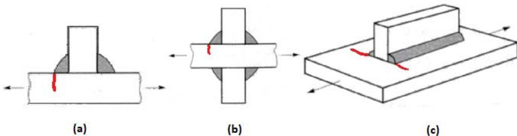
Slika 18. Prikaz mesta nastanka pukotine kod kutnog zavara (zavar ne prenosi opt.) [18]
