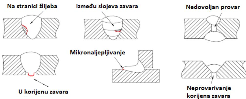
Slika 13. Naljepljivanje (lijevo) i nedovoljan provar (desno) [14]
