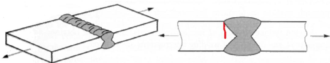
Slika 16. Prikaz mesta nastanka pukotine kod sučevnog zavara (poprečno opterećen) [17]
