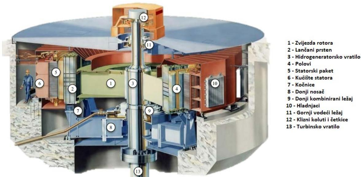
Slika 1. Presjek hidrogeneratorsa sa istaknutim pozicijama dijelova [1]
