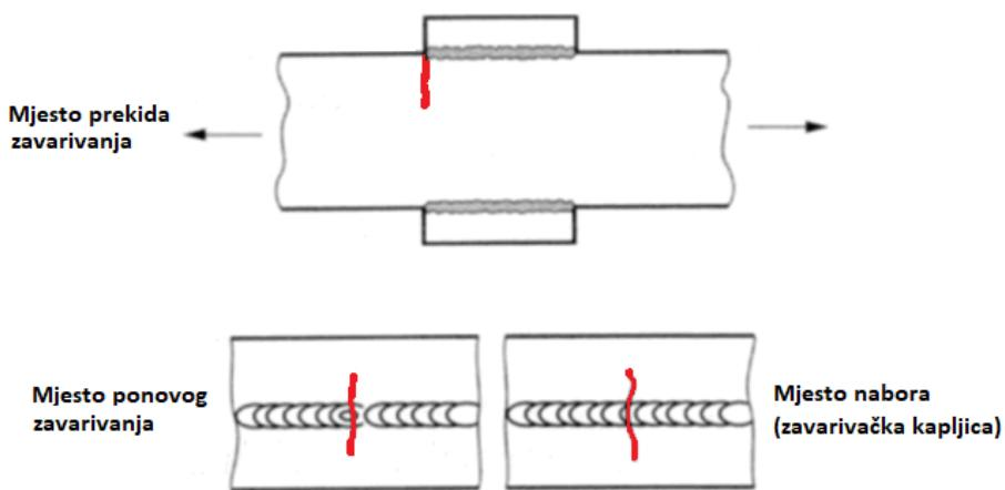
Slika 17. Prikaz mesta nastanka pukotine kod sučevnog zavara (uzdužno opterećen) [17]
