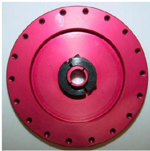
*Slika 5.2 Modul ekscentričnog rotora*
