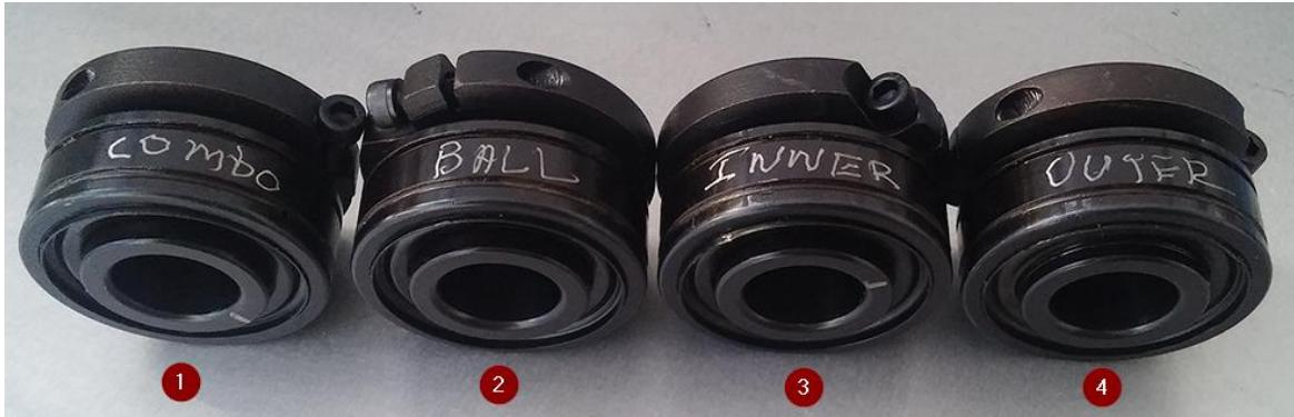
1. Kombinirano oštećenje, 2. oštećenje kotrljajućeg elementa, 3. oštećenje unutarnjeg prstena, 4. oštećenje vanjskog prstena
