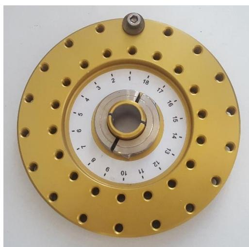
Slika 5.1 Rotor za simulaciju debalansa
