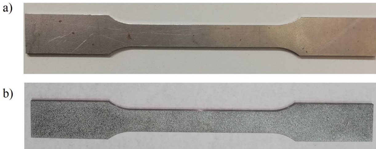
Slika 13. Površina ispitnog uzorka prije (a) i poslije nanošenja teksture (b)
