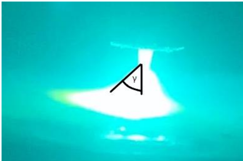
Slika 37. Otklon električnog luka za poziciju 3 (kut \gamma=50^\circ )
