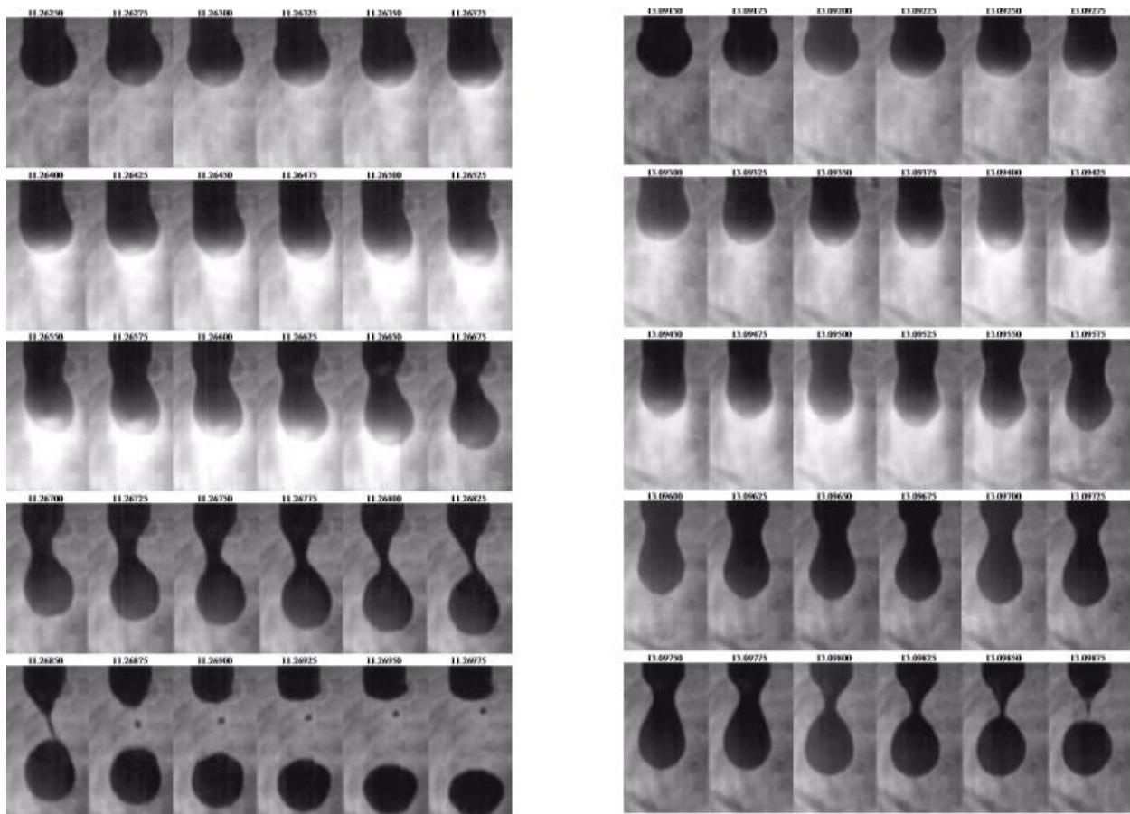
Slika 27. Mehanizam odvanjanja metalne kapljice prilikom MAG zavarivanja [14]
