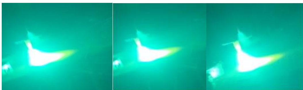
Slika 49. Puhanje luka od ruba radnog komada do kraja pozicije drugog magneta kada je isključen uređaj za demagnetizaciju
