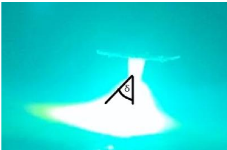
Slika 38. Otklon električnog luka za poziciju 4 (kut \delta=43^\circ )
