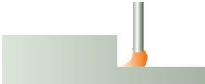
Slika 5. Puhanje električnog luka uslijed različitih debljina radnih komada koji se zavaruju [4]
