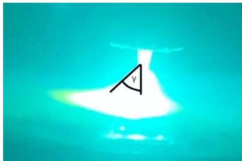
Slika 37. Otklon električnog luka za poziciju 3 (kut  $\gamma=50^\circ$ )
