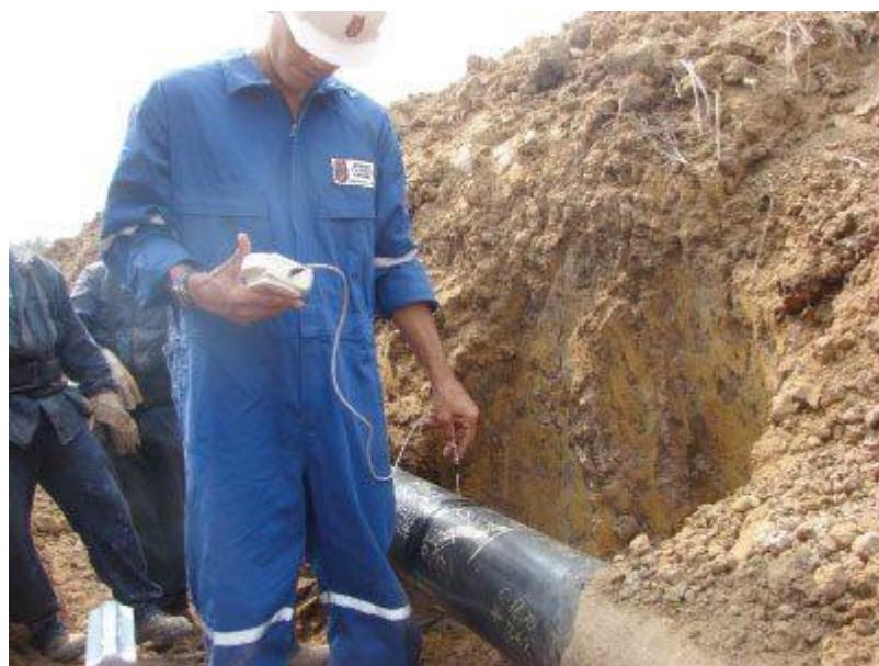
Slika 12. Mjerenje zaostalog magnetizma prije zavarivanja cjevovoda na terenu [10]
