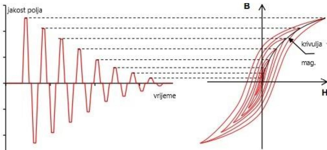
**Slika 15. Stanje magnetskog polja materijala prilikom demagnetizacije promjenom polova DC struje [8]**
