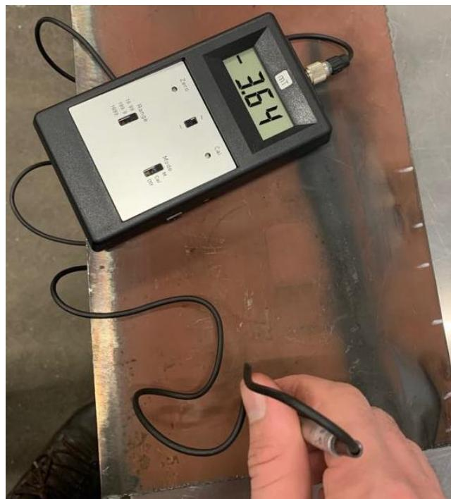
Slika 32. Mjerenje gustoće zaostalog magnetskog polja pomoću Gaussmetra
