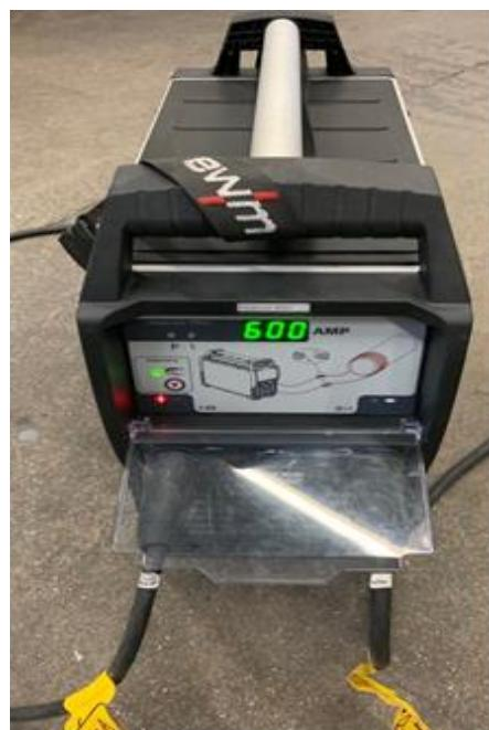
**Slika 40. Uredaj za demagnetizaciju „Degauss 600“**
