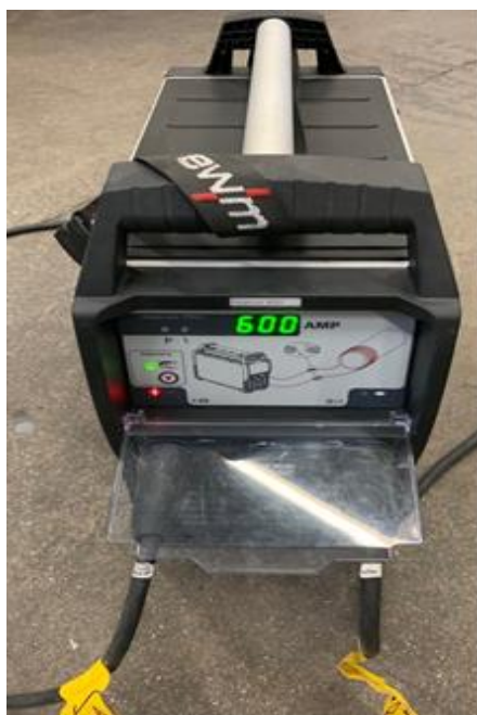
Slika 40. Uređaj za demagnetizaciju „Degauss 600“
