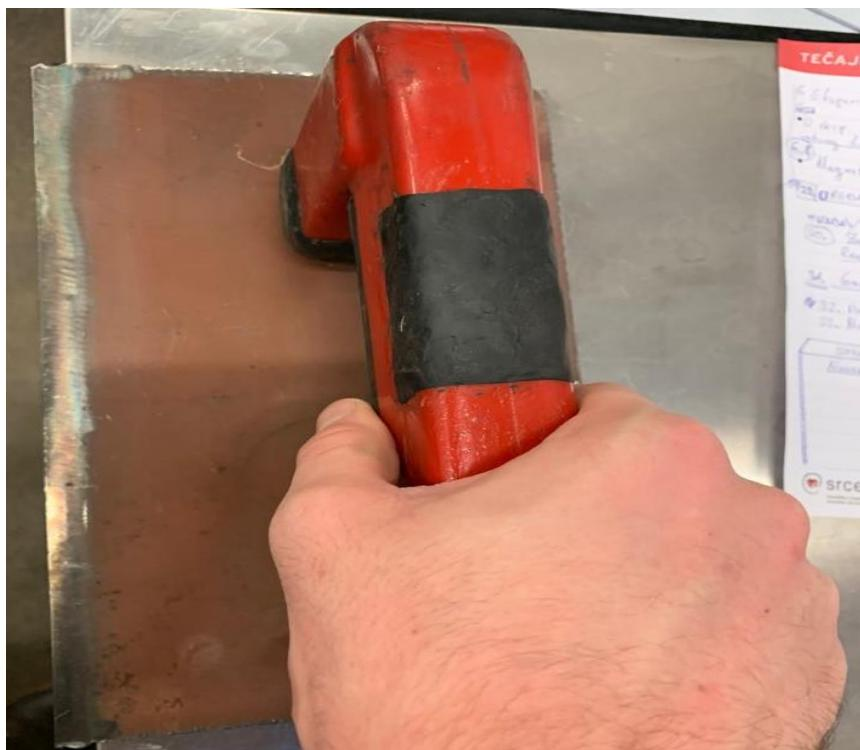
**Slika 29. Provođenje magnetizacije magnetnim jarmom**
