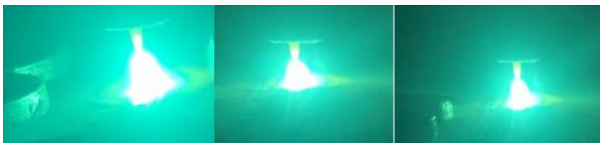
Slika 50. Izgled električnog luka od ruba radnog komada do kraja pozicije drugog magneta kada je uključen uređaj za demagnetizaciju
