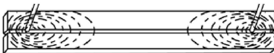
Slika 2. Povećana koncentracija silnica u blizini električnog luka [5]
