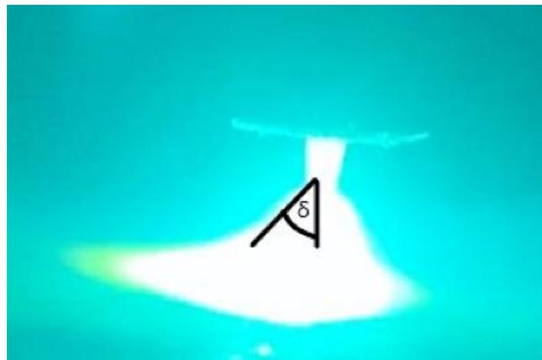
Slika 38. Otklon električnog luka za poziciju 4 (kut  $\delta=43^\circ$ )
