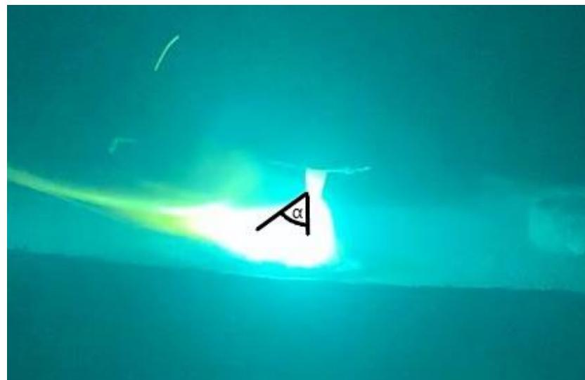
Slika 35. Otklon električnog luka za poziciju 1 (kut  $\alpha=65^\circ$ )
