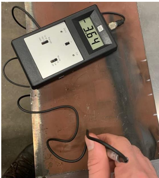
Slika 32. Mjerenje gustoće zaostalog magnetskog polja pomoću Gaussmetra
