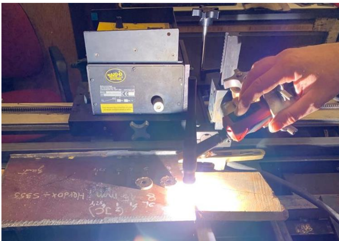
Slika 34. Navarivanje TIG postupkom
