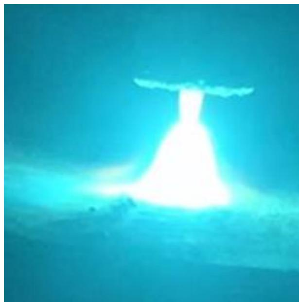
Slika 44. Izgled električnog luka za vrijeme navarivanja nakon provedene demagnetizacije
