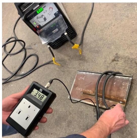
Slika 41. Mjerenje gustoće magnetskog polja za vrijeme demagnetizacije
