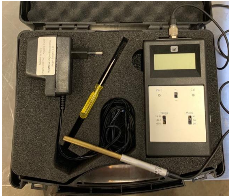
Slika 30. Gauss metar „Fieldmeter H1-4“
