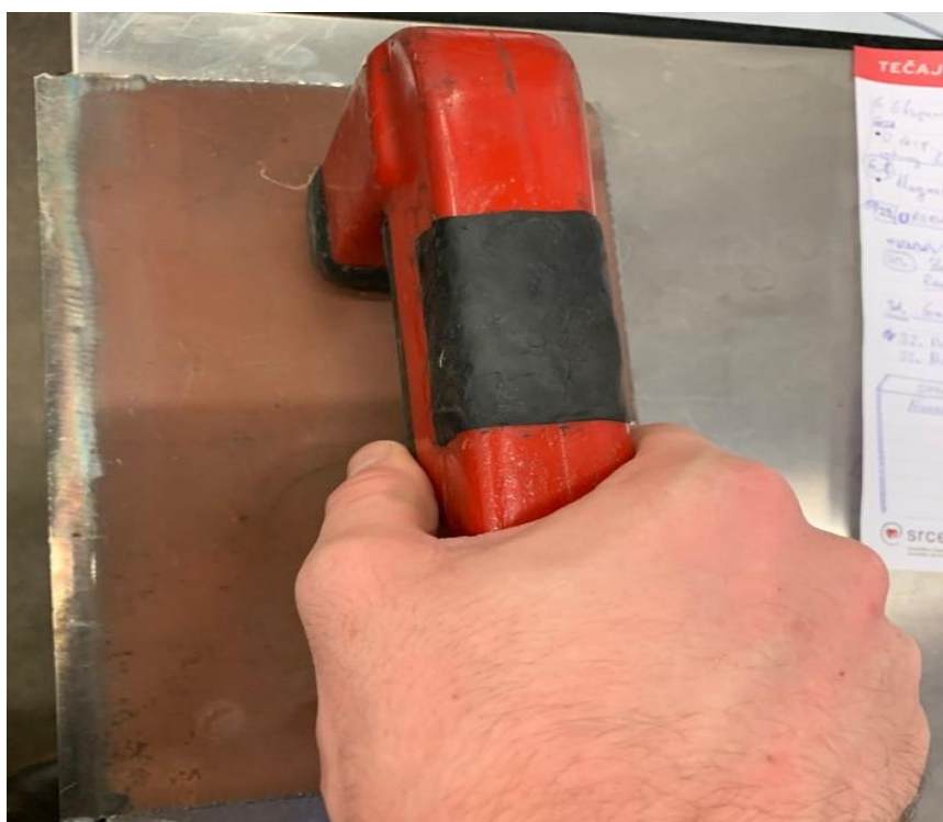
Slika 29. Provođenje magnetizacije magnetnim jarmom
