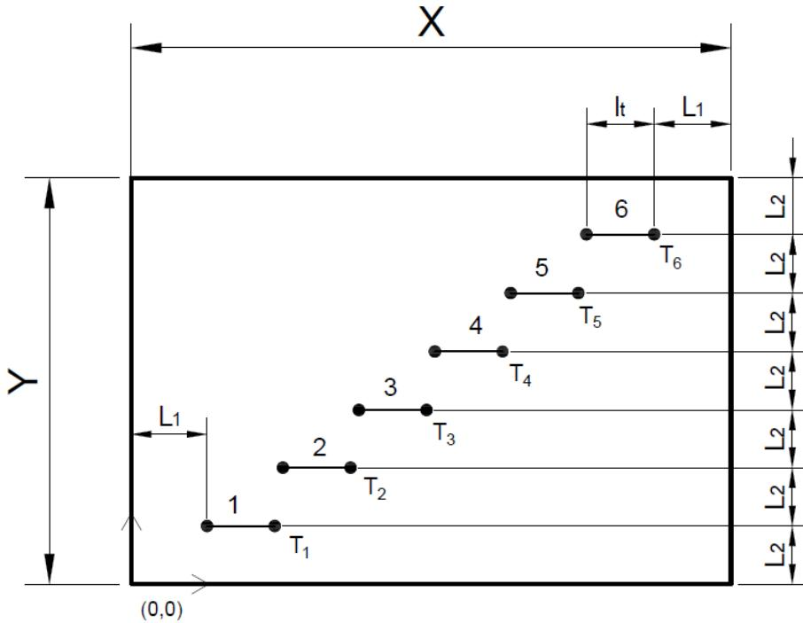
Slika 30. Raspored mjernih tragova – Tip 3
