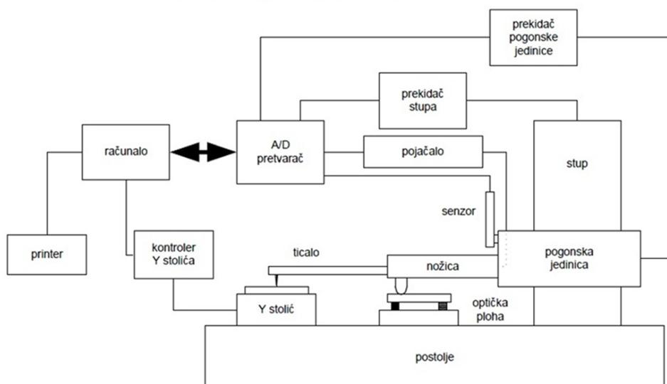
Slika 9. Osnovni dijelovi električko-mehaničkog uređaja s ticalom [2]
