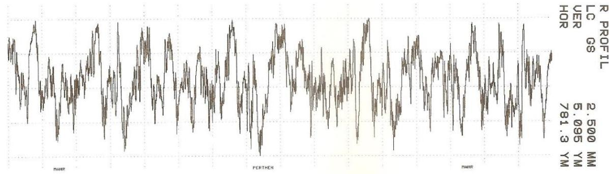
**Slika 101. Grafički prikaz prvog traga iz treće serije mjerena (irregularni profil)**
