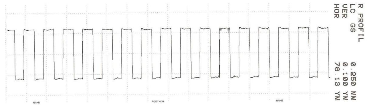
Slika 64. Grafički prikaz četvrtog traga iz treće serije mjerjenja (pravokutni profil)
