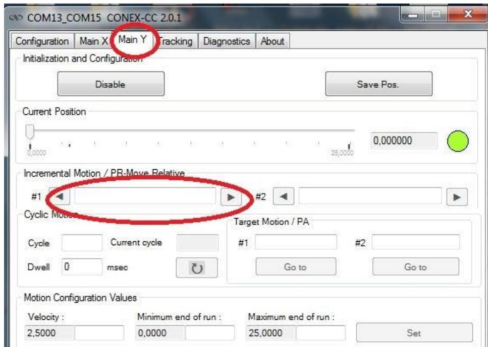
Slika 48. Način unošenja pomaka translacijskog elementa u smjeru Y osi
