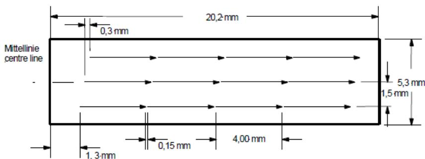
**Slika 17. Način provođenja umjeravanja prema EURAMET protokolu [8]**
