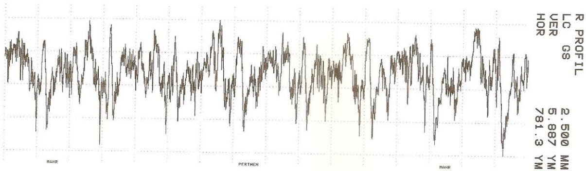
Slika 103. Grafički prikaz trećeg traga iz treće serije mjerjenja (irregularni profil)
