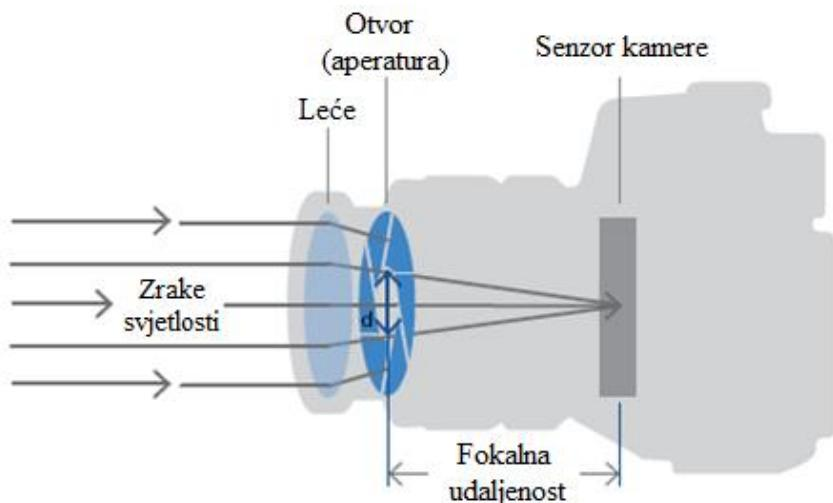
**Slika 19. Osnovni dijelovi digitalne kamere [9]**
