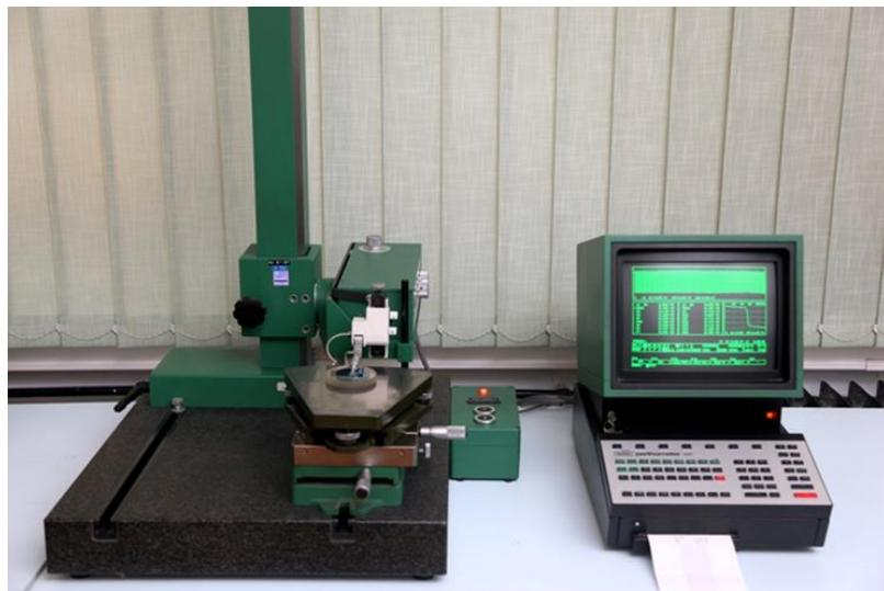
**Slika 12. Uređaj Perthometer S8P [2]**
