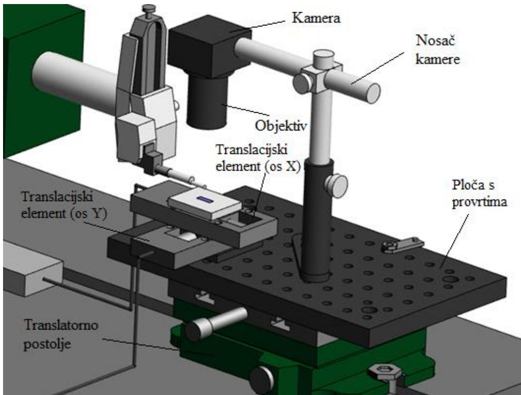
Slika 14. Dijelovi nadograđenog mjernog uređaja Perthometer S8P
