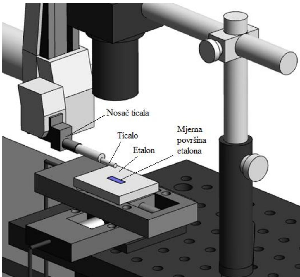
Slika 15. Dijelovi nadograđenog mjernog uređaja Perthometer S8P
