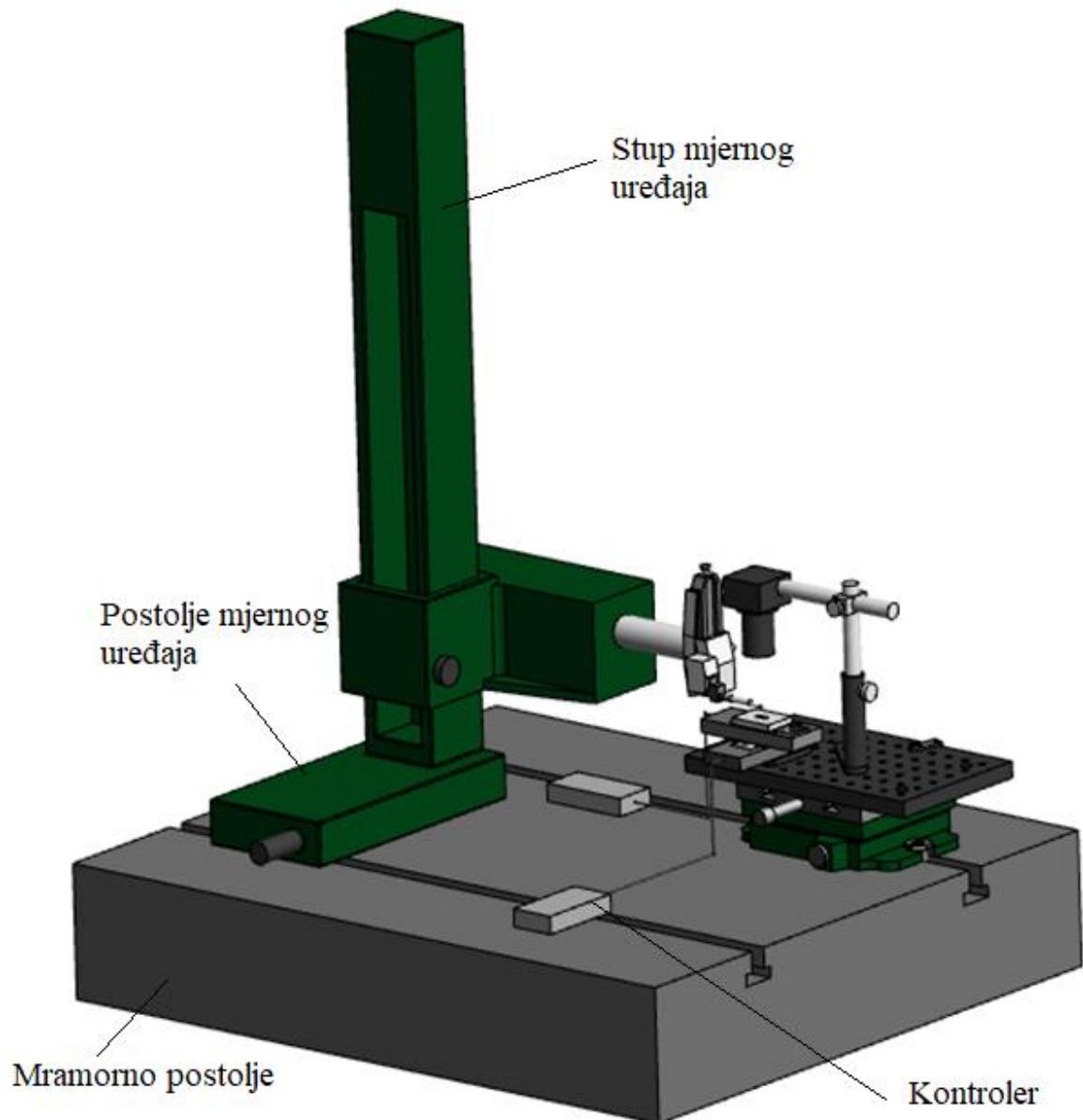
Slika 13. Model nadograđenog mjernog uređaja Perthometer S8P
