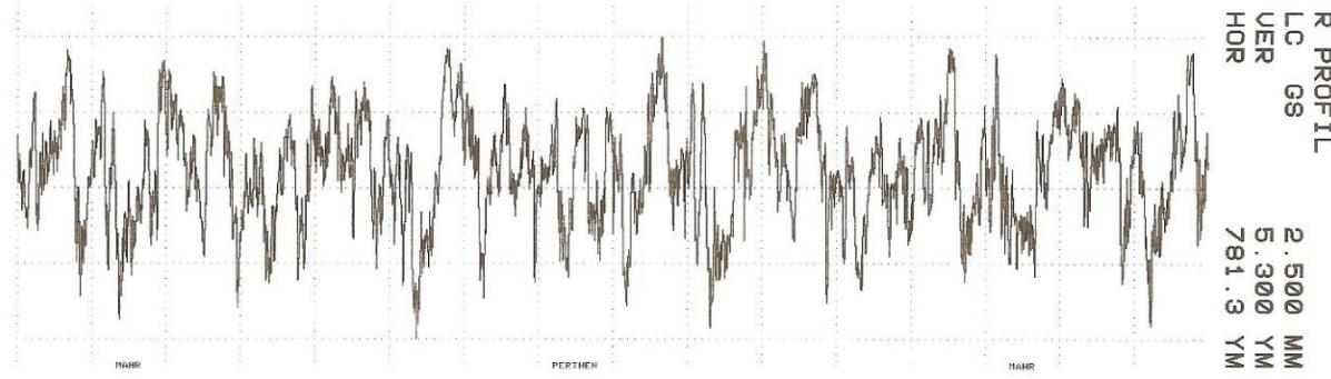
**Slika 102. Grafički prikaz drugog traga iz treće serije mjerena (irregularni profil)**
