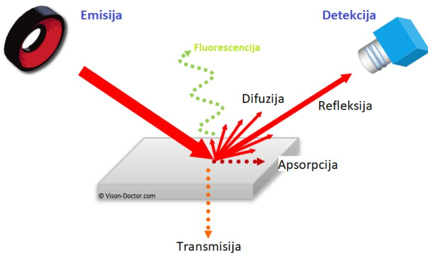
**Slika 24. Interakcija svjetlosti i osvjetljivanje površine [13]**
