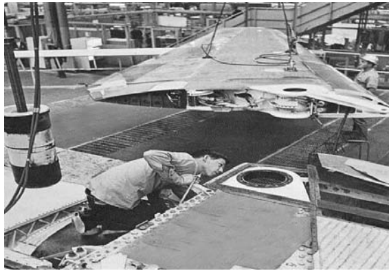
Slika 2.5 Pregled spornog dijela konstrukcije prizemljenog zrakoplova
