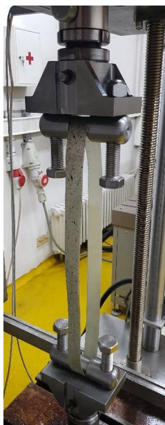
Slika 51. Uzorak pozicioniran na kidalici
