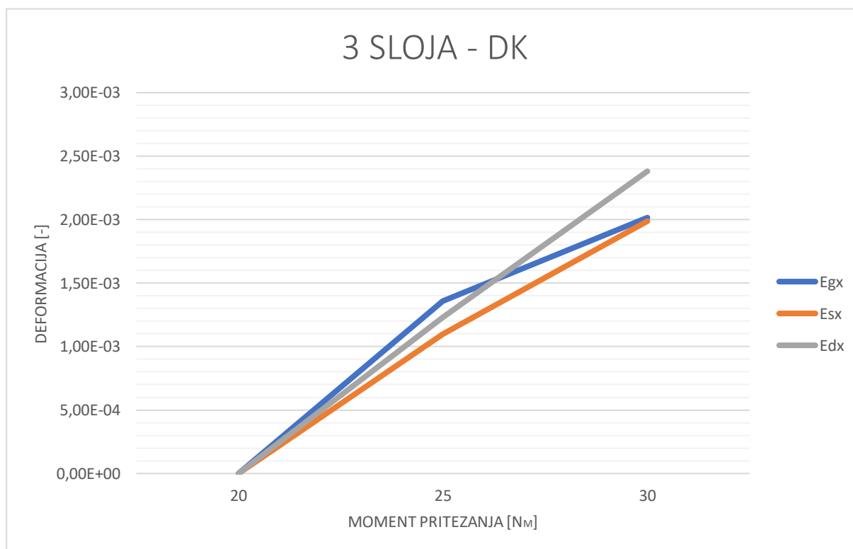
Slika 84. Deformacije steznog elementa s 3 sloja na mjernom mjestu DK
