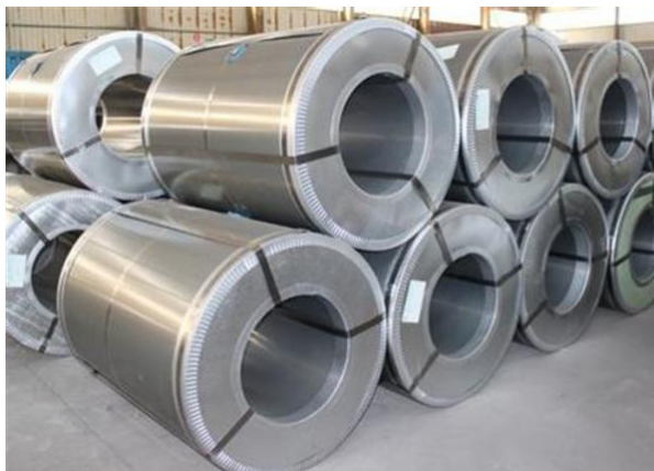
Slika 21. Rola čeličnog transformatorskog lima [24]
