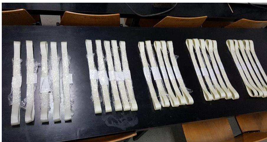
Slika 49. Uzorci steznih elemenata prije ispitivanja
