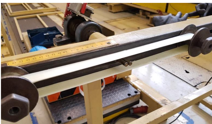
Slika 41. Namotana i polimerizirana traka spremna za skidanje s namatalice
