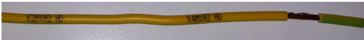
Slika 34. Žica na kojoj print zadovoljava zahtjeve za kvalitetu
