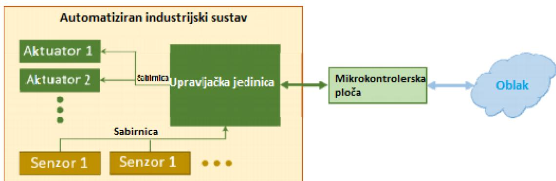
Slika 4. Proširenje sustava pomoću ploče mikrokontrolerla [6]
