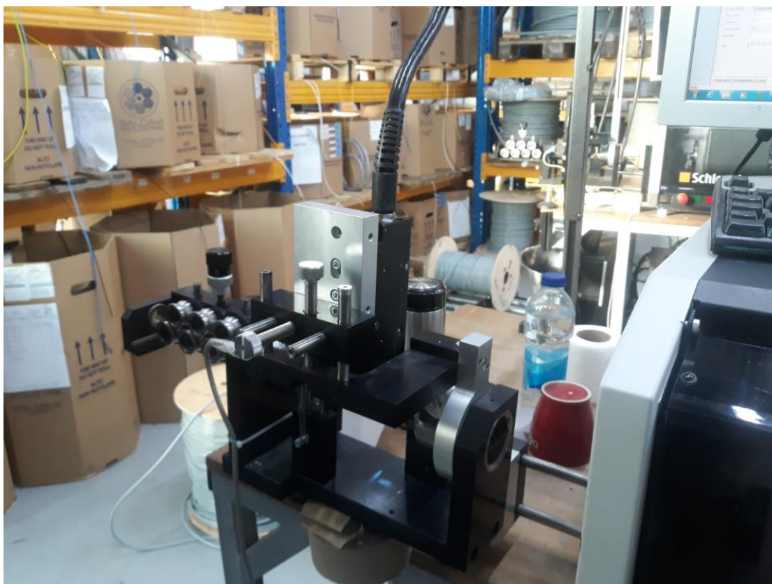
Slika 32. Stroj za printanje po žici
