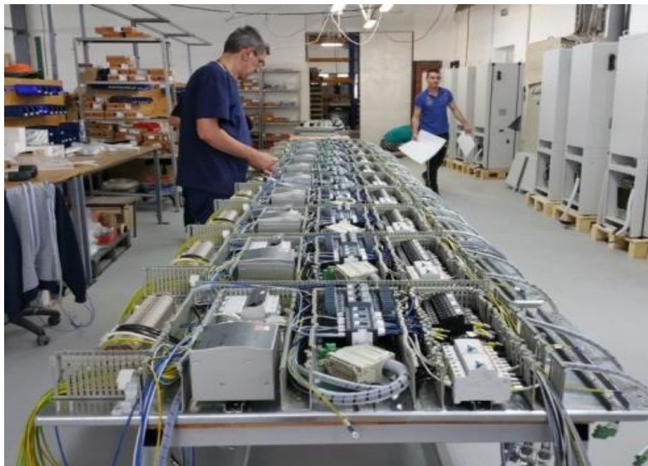
Slika 23. Proizvodnja ožičenja za elektro ormare u PIMS Elektro Oprema [22]
