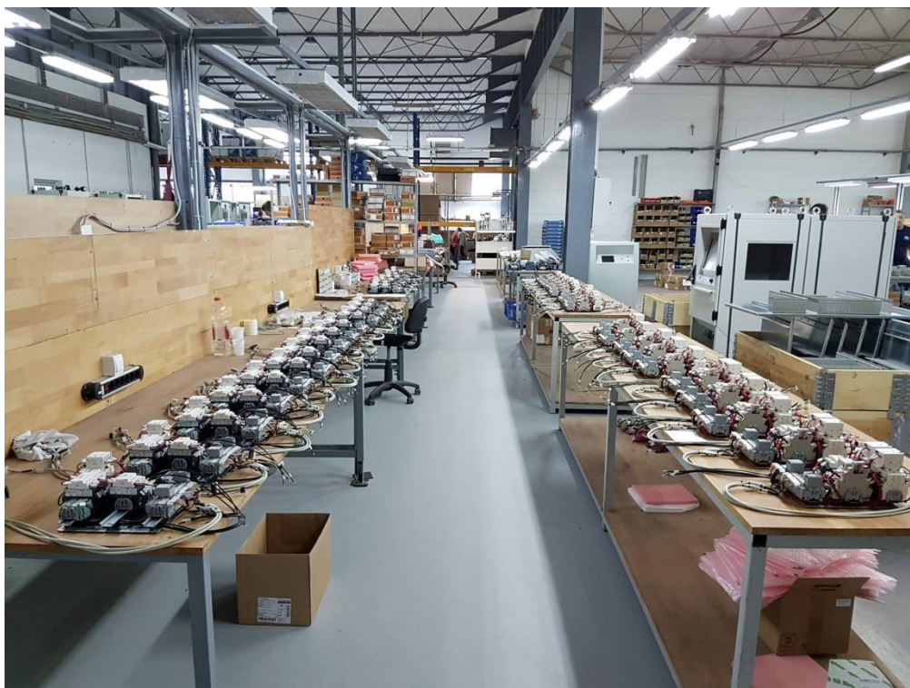
Slika 35. Linija za sklapanje upravljačkih jedinica [22]
