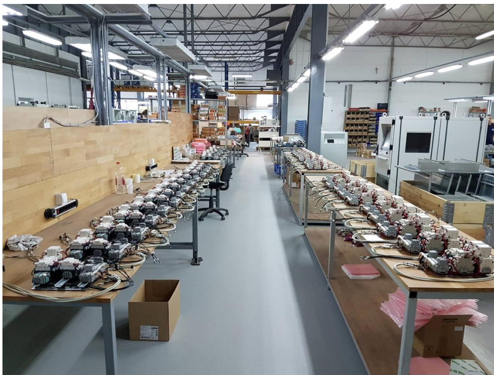
Slika 35. Linija za sklapanje upravljačkih jedinica [22]
