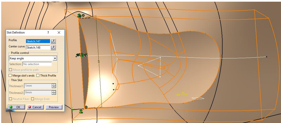
Slika 65. Slot operacija za oblikovanje usta
