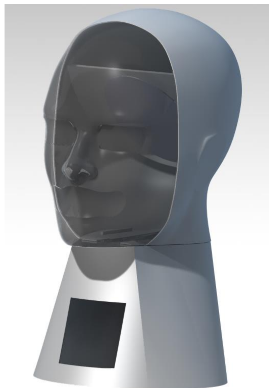
Slika 93. Sklop druge verzije glave afektivnog robota
