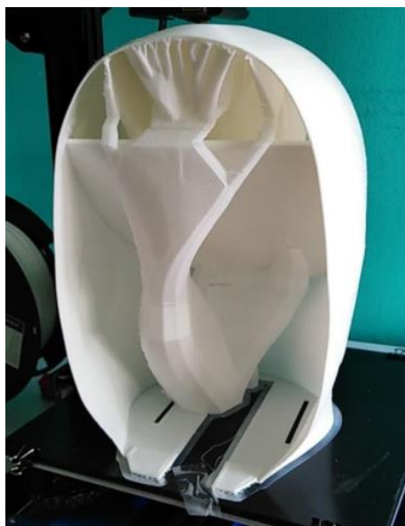
Slika 95. Izrada stražnjeg dijela glave na 3D printeru
