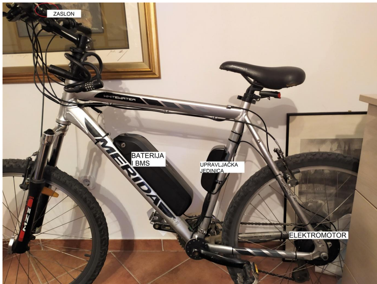
Slika 12. E-bicikl s komponentama električnog sklopa
