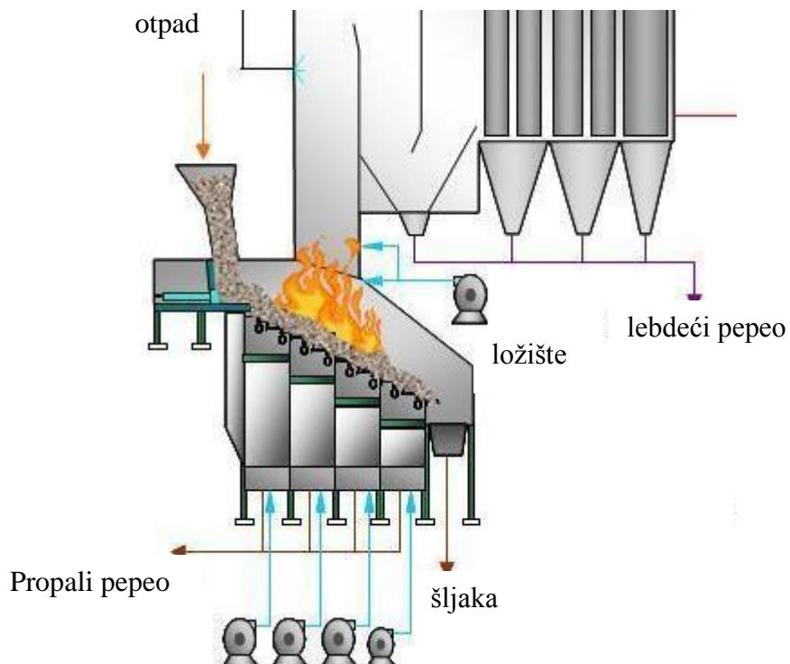
Slika 12. Shematski prikaz postrojenja za izgaranje otpada na rešetci [25]
