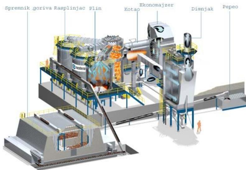
Slika 16. Shematski prikaz termoenergetskog postrojenja s rasplinjavanjem
