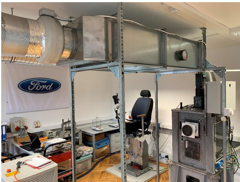
Slika 46. Ventilacijski sustav ispitnog postava
