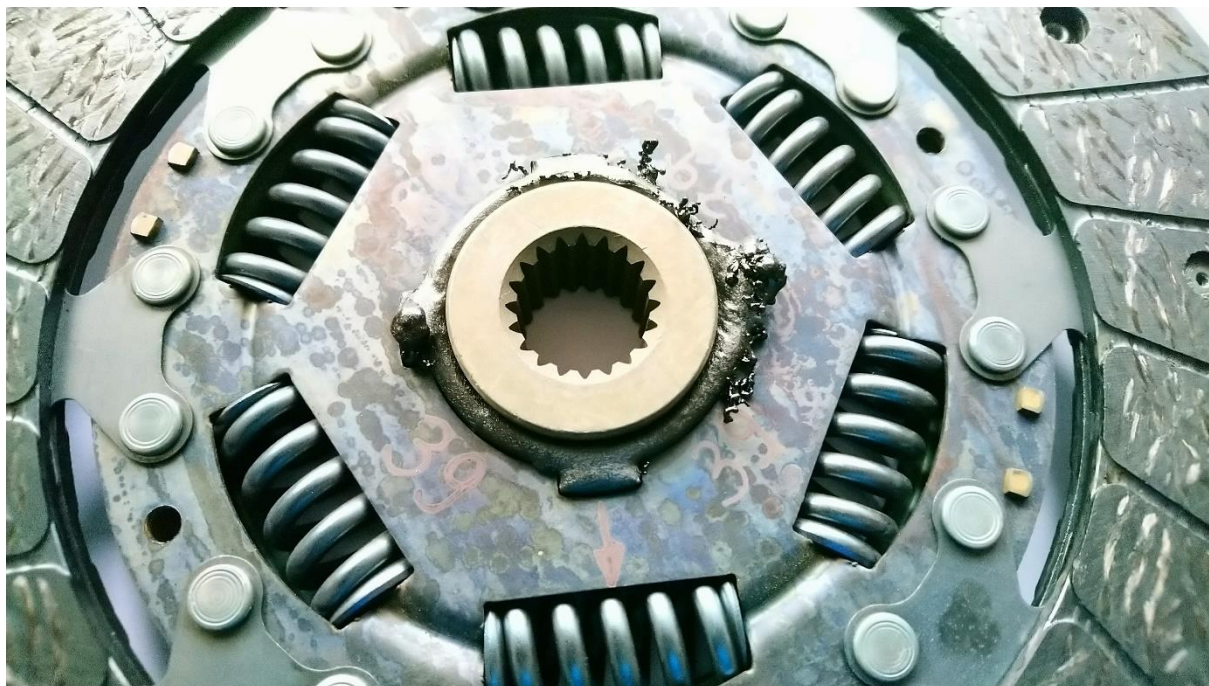
Slika 64. Rastopljeni klizni ležaj tarne ploče #39 nakon sušenja u električnoj pećnici
