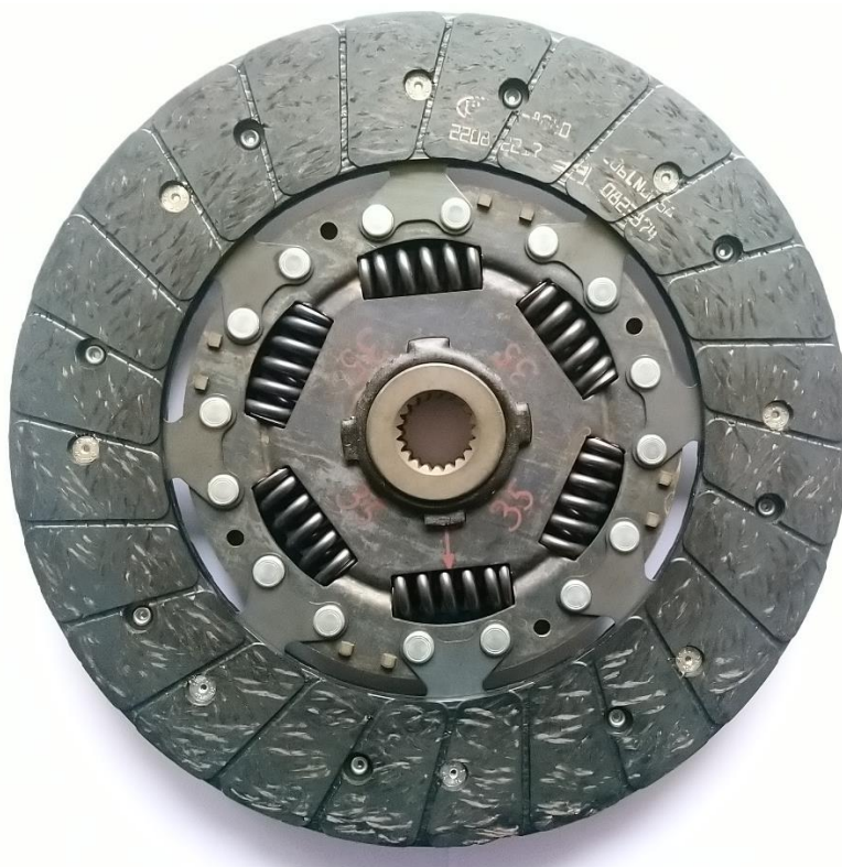
Slika 63. Tarna ploča #35 nakon sušenja u električnoj pećnici
