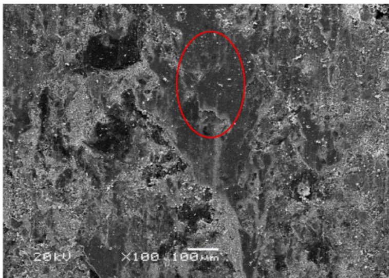
Slika 37. Formirani tarni sloj na organskom tarnom materijalu snimljen skenirajućim elektronskim mikroskopom (SEM) ([20])
