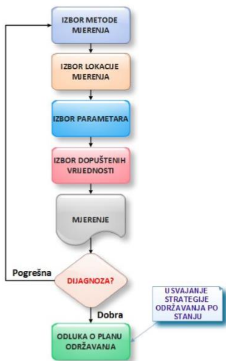
Slika 2. Postupak uvođenja održavanja po stanju kontrolom parametra [2]
