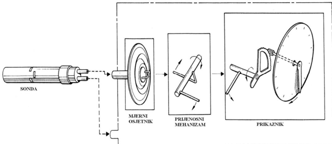
Slika 2.2. Prikaz funkcijskih cjelina zrakoplovog instrumenta [1].
