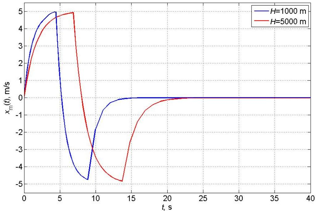
Slika 5.25. Prikaz indicirane brzine  $x_m(t)$  za  $T = T_1 = T_2 = 4 \cdot \lambda$ ,  $H=1000 \text{ m}$  i  $H=5000 \text{ m}$ .
