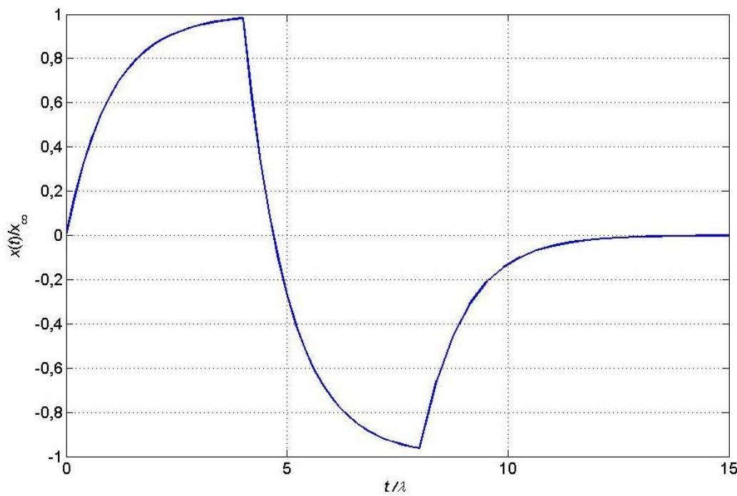
Slika 5.8. Prikaz indicirane brzine  $x(t)$  za  $T = T_1 = T_2 = 4 \cdot \lambda$ ,  $H = 1000$  m.
