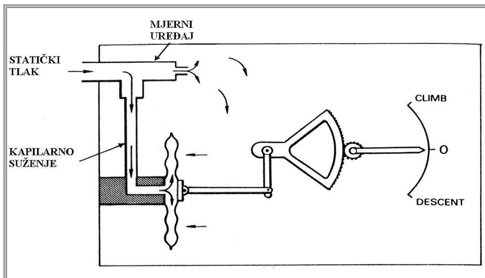
Slika 2.6. Prikaz osnovnih elemenata uređaja za mjerjenje vertikalne brzine zrakoplova [1].
