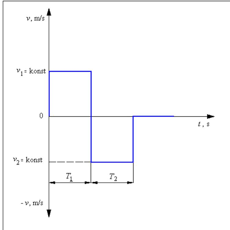
Slika 4.2. Graf vremenske ovisnosti vertikalne brzine zrakoplova
