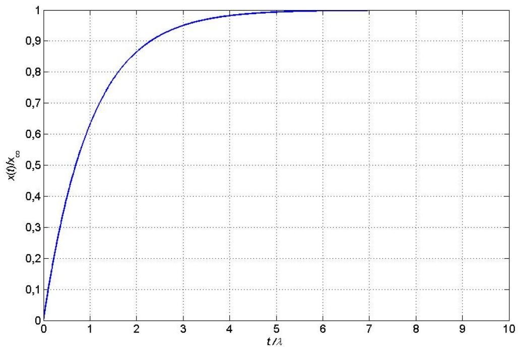
Slika 5.5. Prikaz indicirane brzine  $x(t)$  za zadanu vertikalnu brzinu  $v(t)$ ,  $H = 5000$  m.
