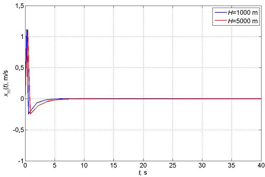
Slika 5.26. Prikaz indicirane brzine  $x_m(t)$  za  $T = T_1 = T_2 = 0,25 \cdot \lambda$ ,  $H = 1000 \text{ m}$  i  $H = 5000 \text{ m}$ .
