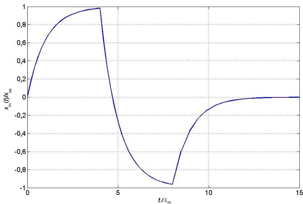
Slika 5.23. Prikaz indicirane brzine  $x_m(t)$  za  $T = T_1 = T_2 = 4 \cdot \lambda$ ,  $H = 5000$  m.
