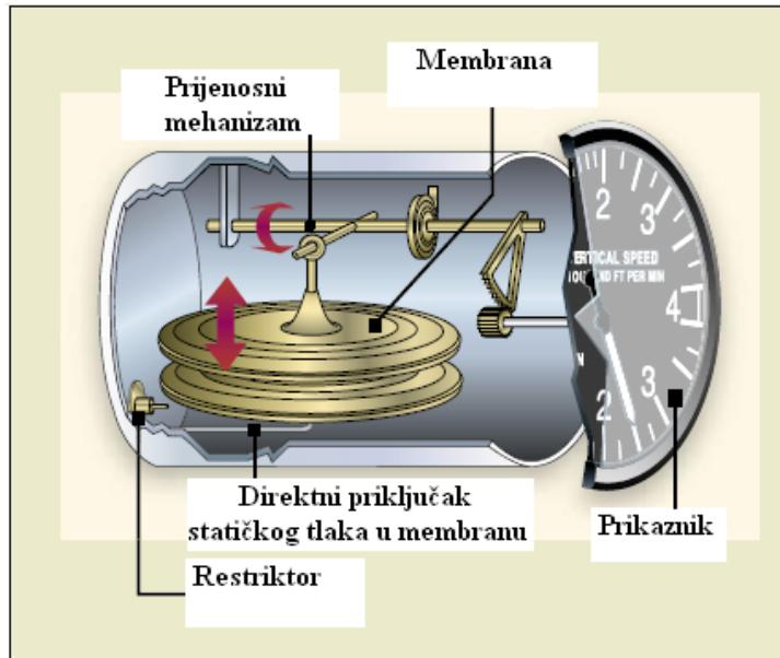
Slika 2.7. Shematski prikaz rada standardnog variometra [4].
