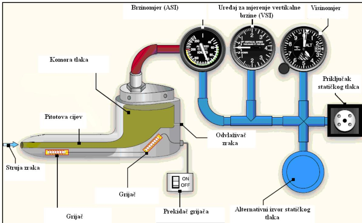
Slika 2.5. Pitot-statički sustav napajanja tri primarna instrumenta [4].
