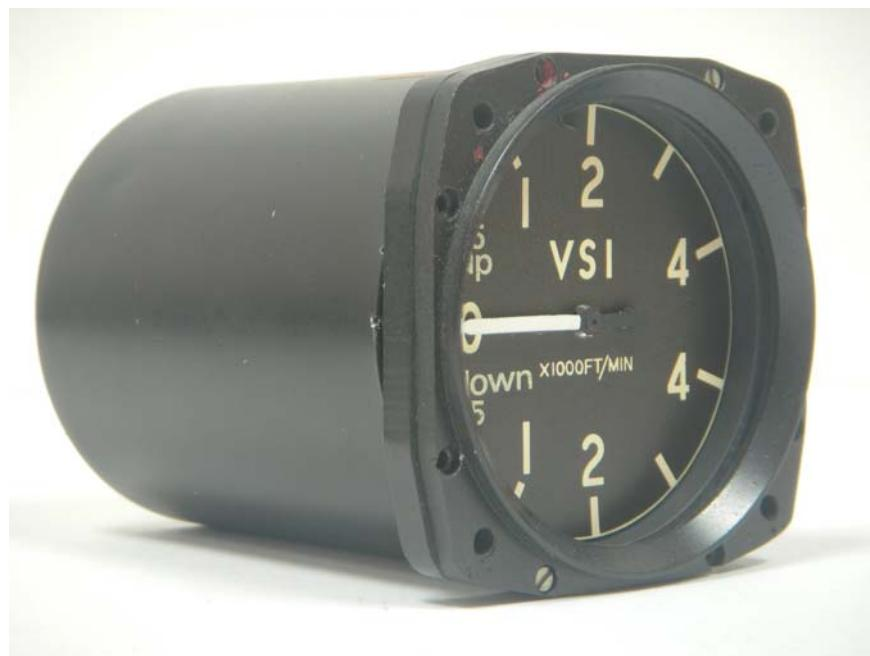
Slika 2.1. Uredaj za mjerjenje vertikalne brzine zrakoplova (1000 ft/min~5m/s).
