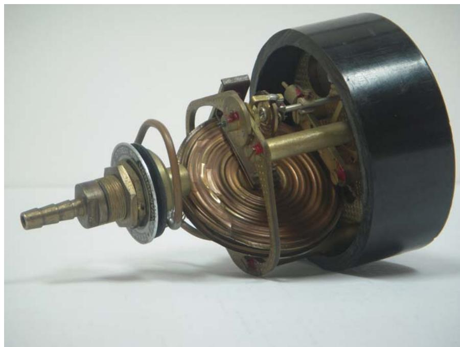
Slika 2.9. Variometar s piezokeramikom, promjer kućišta 70 mm.
