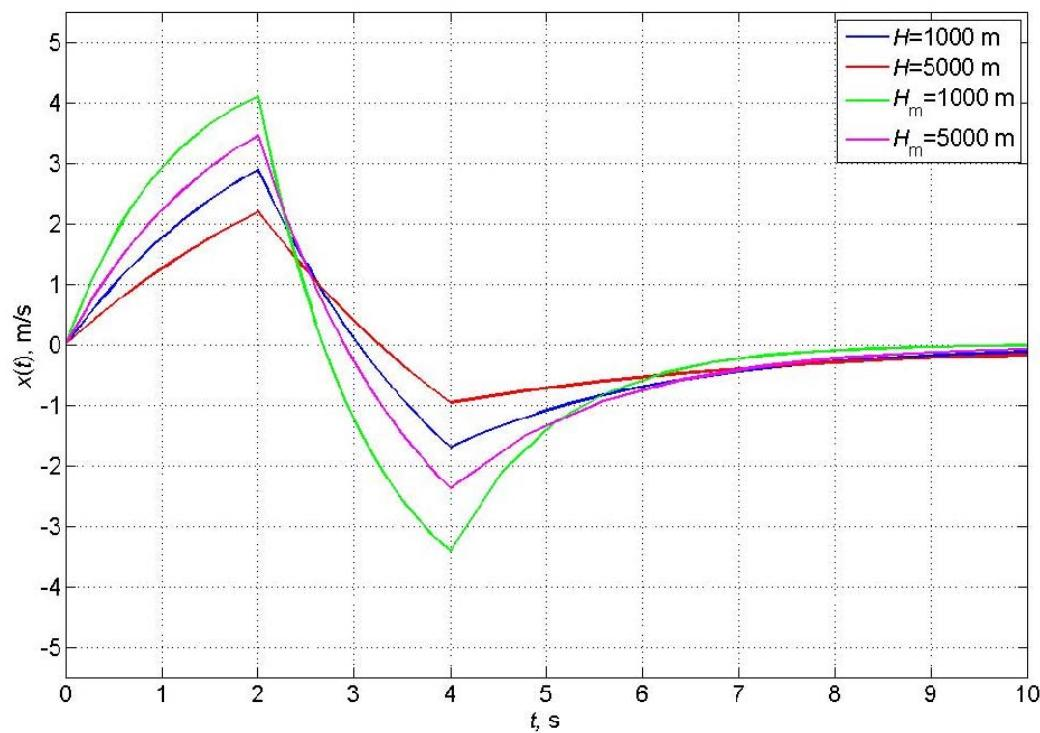
Slika 5.37. Usporedba odziva indicirane brzine osnovnog i modificiranog modela za
