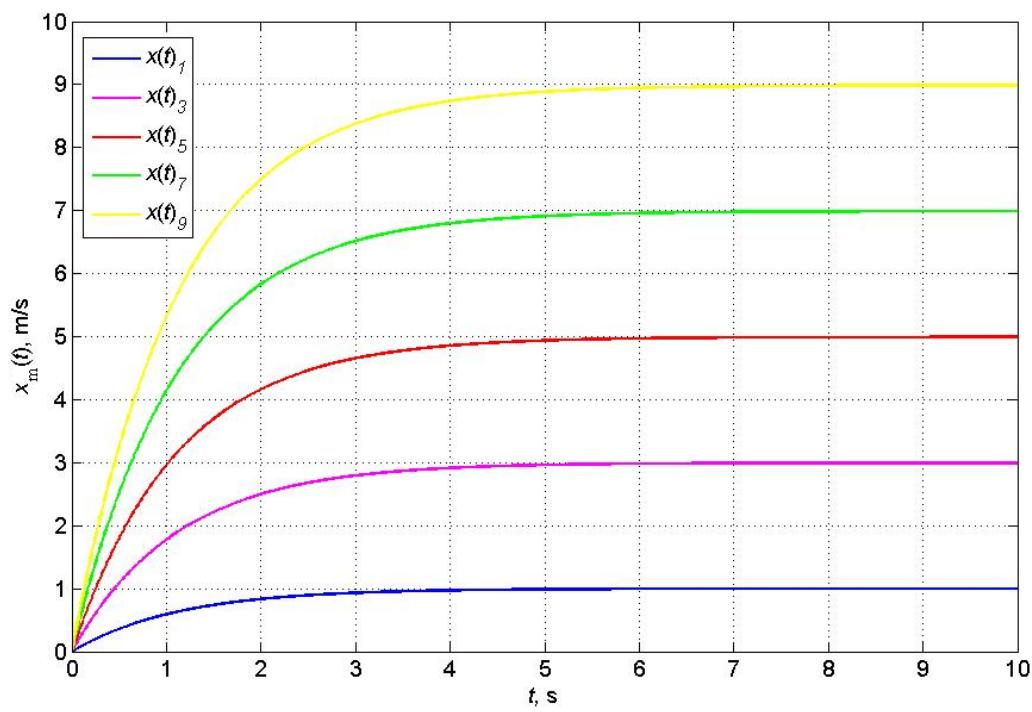
Slika 5.17. Prikaz indicirane brzine  $x_m(t)$  za različite  $v(t)$ ,  $H = 1000$  m.
