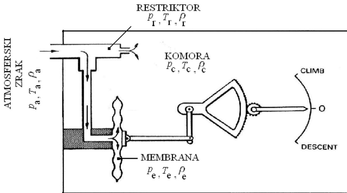
Slika 3.3. Shematski prikaz osnovnog modela uređaja za mjerjenje vertikalne brzine [3].
