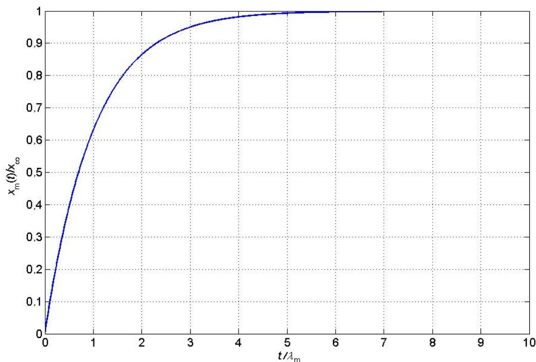
Slika 5.18. Prikaz indicirane brzine  $x_m(t)$  za zadalu vertikalnu brzinu  $v(t)$ ,  $H = 5000$  m.
