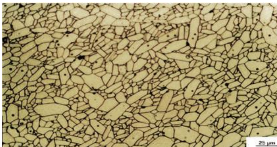
Slika 17. Mikrostruktura sinterirane aluminijske oksidne keramike [15]
