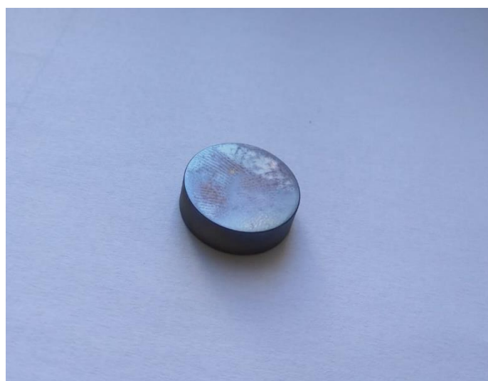
Slika 8.1. Uzorak anodiziran na 30V s greškom na površini
