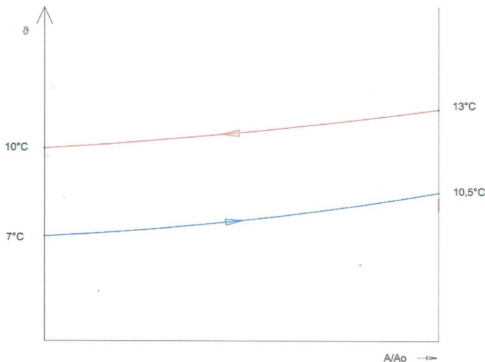
Slika 5.7 Temperature struja na ulazu i izlazu iz međuizmjenjivača topline (grijanje)
