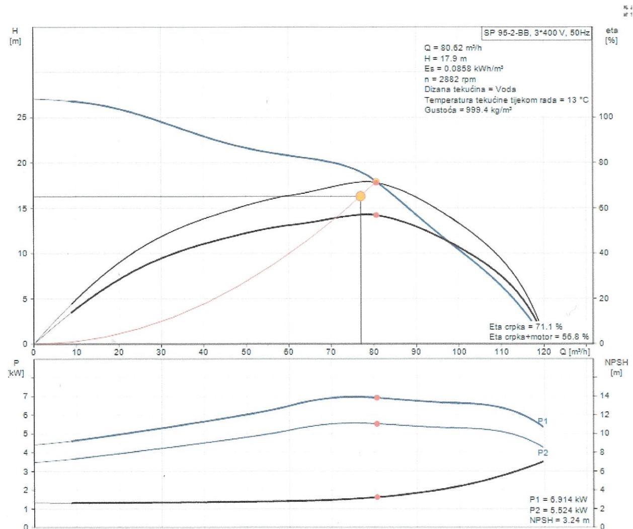
Slika 5.11 Karakteristike pumpe i prikaz radne točke
