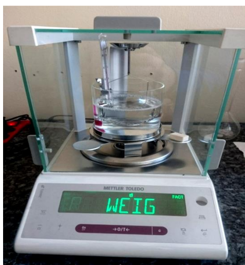
Slika 35. Mjerenje mase uzorka Al 2 O 3 na zraku
