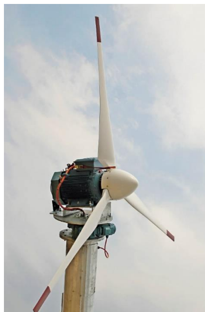
Slika 3.3. AGI FROST ventilator
