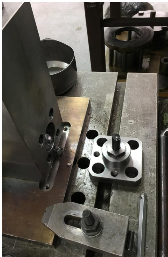
Slika 26. Izbacivanje ECAP -iranih uzoraka iz alata.
