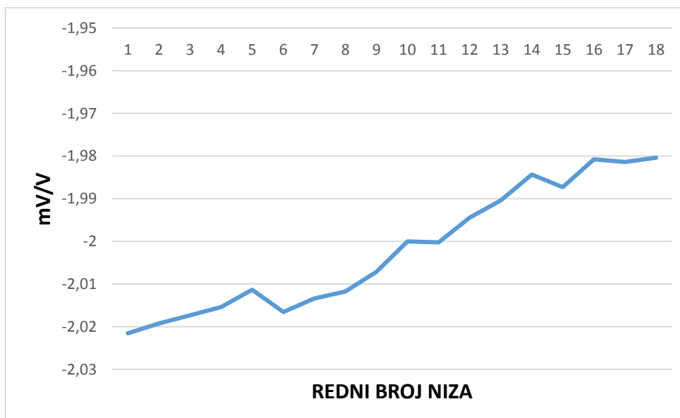
Slika 33 Prikaz nul vrijednosti pri nazivnim vrijednostima sile
