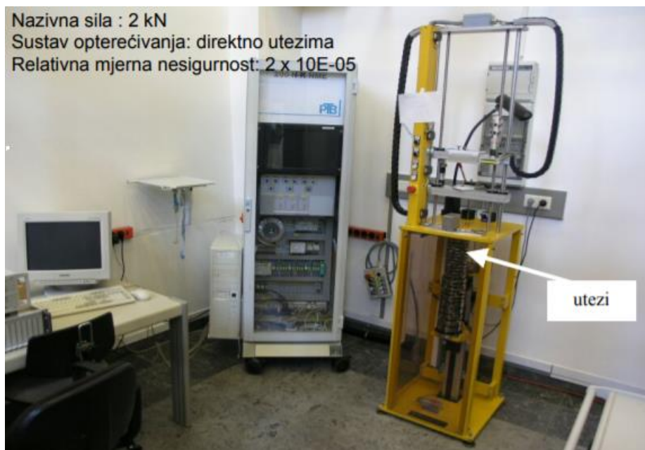
Slika 3 Nacionalni etalon sile Njemačke u PTB-u [4]
