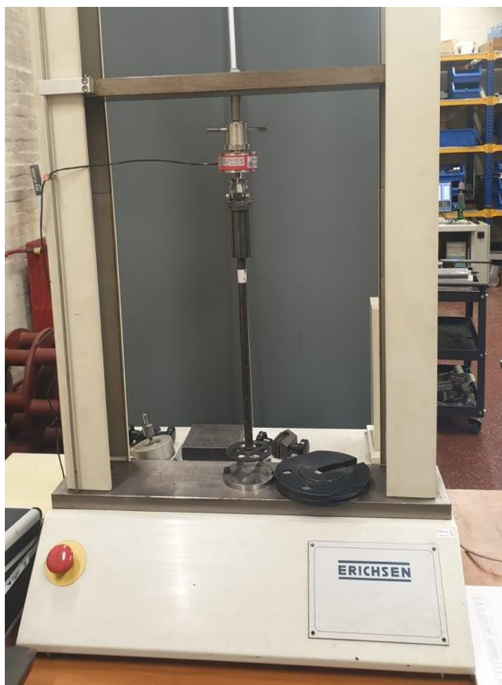
Slika 18 Nosiva konstrukcija „Erichsen 474-2kN“
