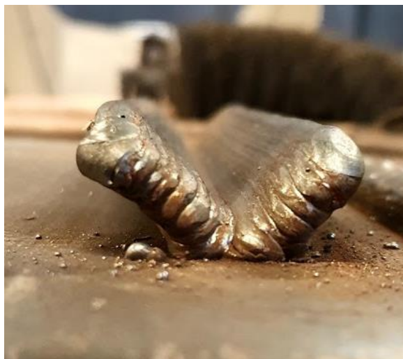
Slika 25. Prikaz problema sa slaganjem profila
