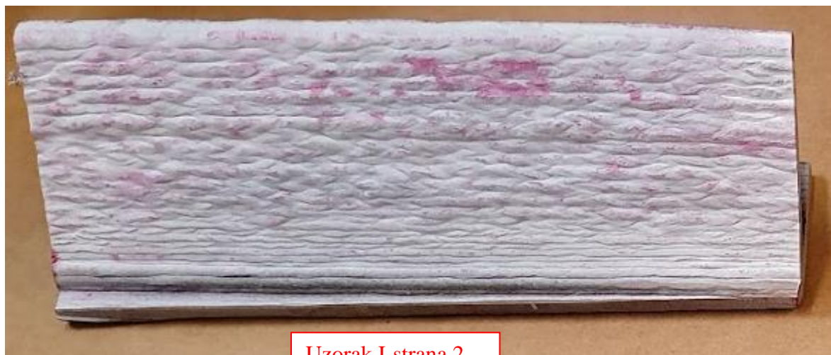
Slika 45. Rezultati penetrantske metode na strani 2 uzorka I
