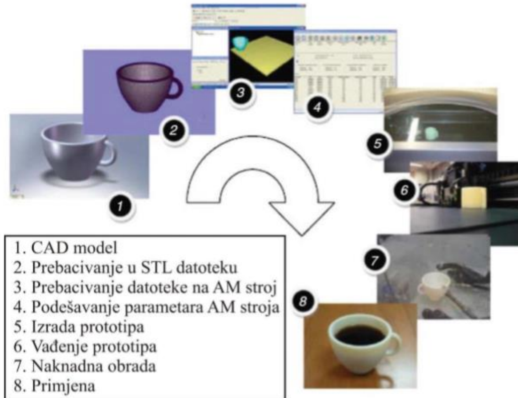
Slika 1. Koraci izrade predmeta aditivnom tehnologijom [2]
