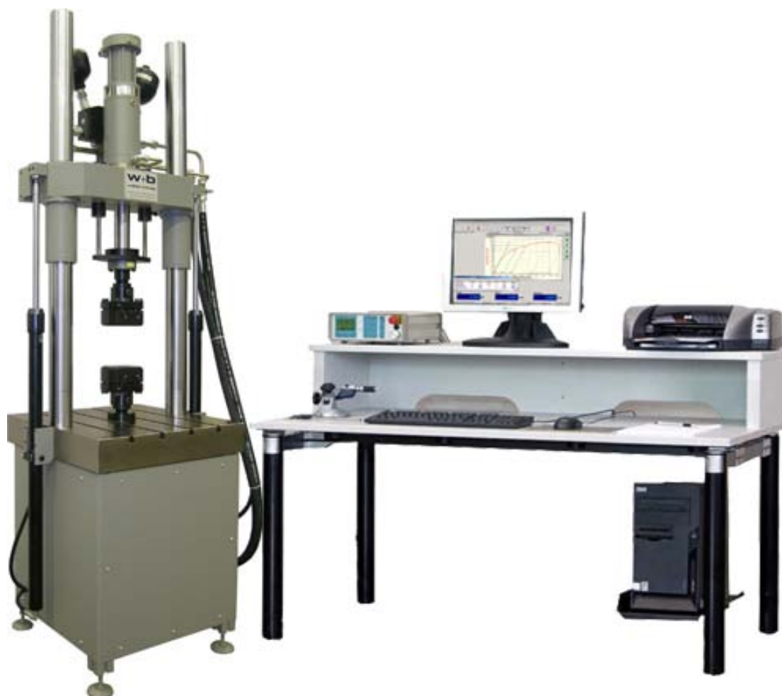
Slika 5.16. Servohidraulička kidalica LFV 50-HH s upravljačkom jedinicom
