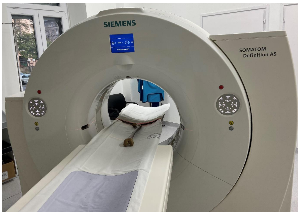
Slika 27. Snimanje modela umjetne kosti CT uređajem
