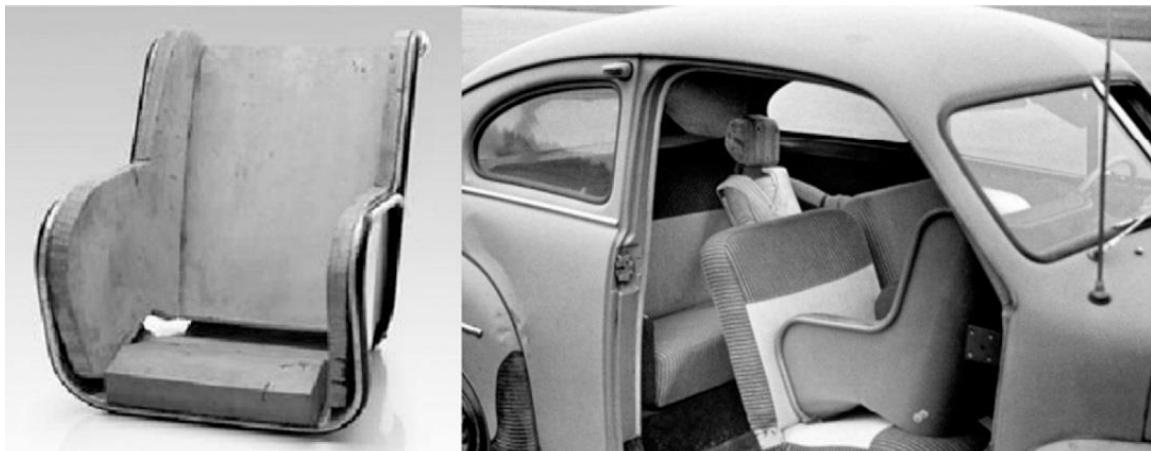
Slika 8 Sjedalica s postavljanjem suprotno smjeru vožnje u Volvu PV544 [5]
