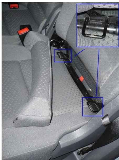
Slika 19 Isofix pričvršna mjesta na šasiji vozila [14]
