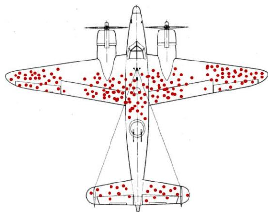
Slika 1 Oštećeni dijelovi zrakoplova koji su se uspjeli vratiti u bazu [2]
