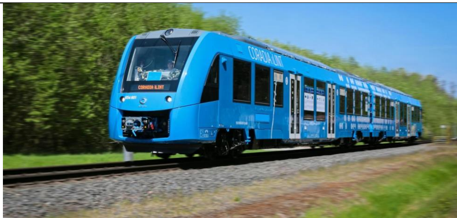
Slika 15. Alstom Croadial iLint vlak na vodik [56]
