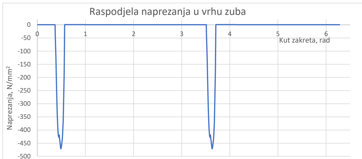
Slika 44. Graf raspodjele tlačnih napreznja u vrhu zuba
