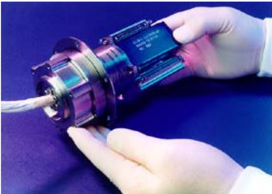
Slika 30. Aktuator satelita s ugrađenim harmonijskim prijenosnikom [11]
