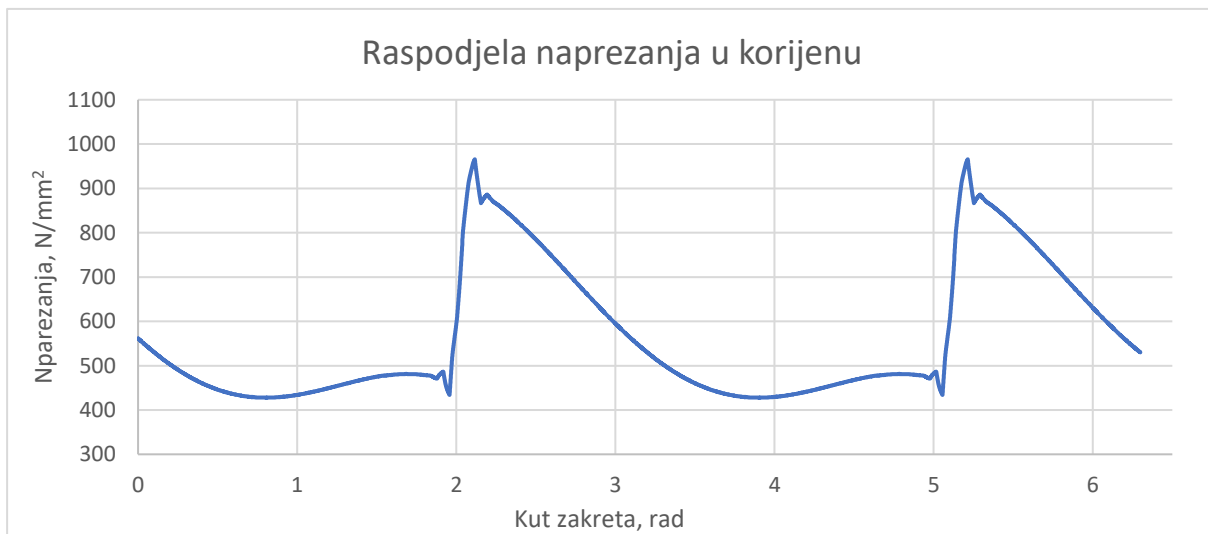
Slika 42. Graf raspodjele vlačnih naprezanja u korijenu zuba
