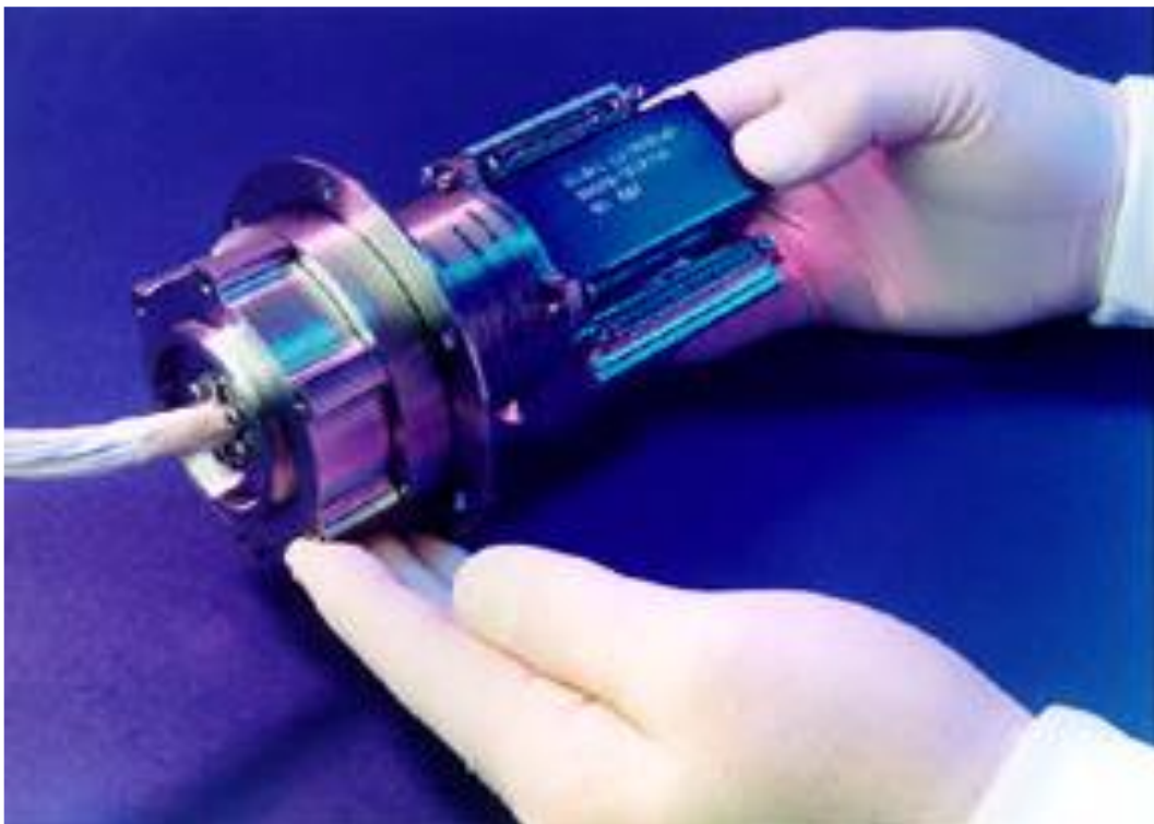
Slika 30. Aktuator satelita s ugrađenim harmonijskim prijenosnikom [11]
