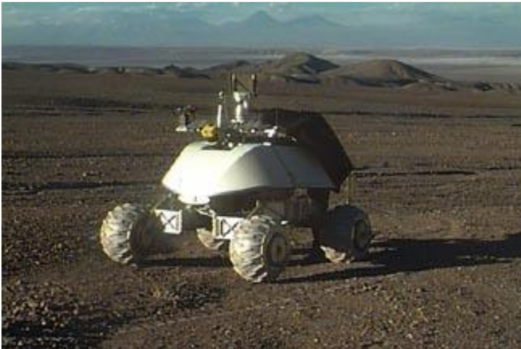
Slika 29. Svemirski rover –harmonijski prijenosnik u kotačima [11]
