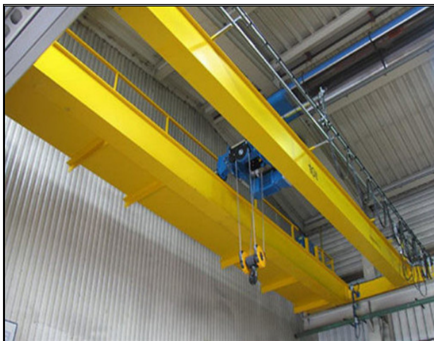
Slika 9. Mosni granik proizvođača Weihua Crane – dva glavna nosača [8]
