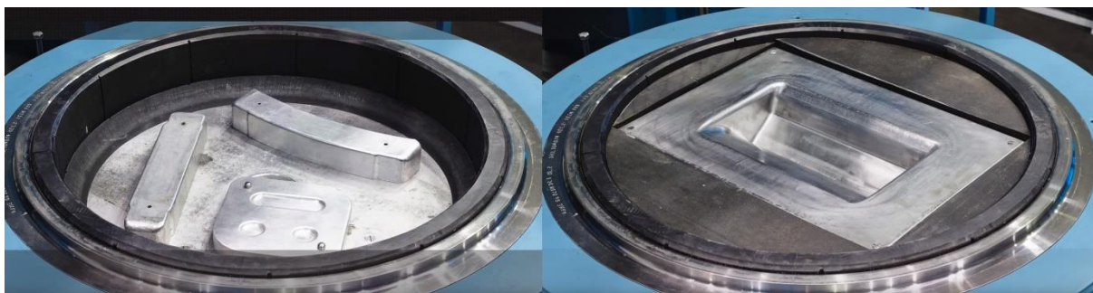
Slika 43. Donji dio alata preše za hidrooblikovanje [36]
