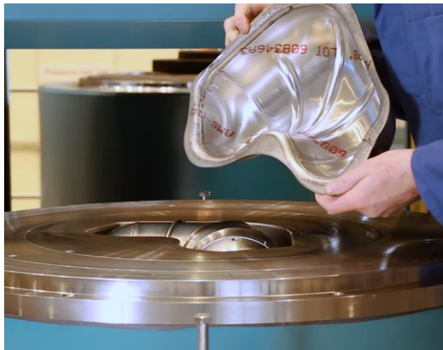
Slika 46. Alat za hidrooblikovanje limova [36]
