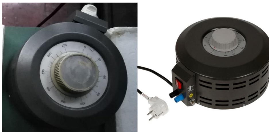
Slika 18. Varijabilni transformator korišten tijekom mjerenja (lijevo). Nova izvedba (desno).
