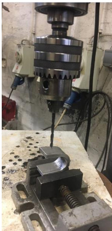
Slika 43. Bušenje provrta na uzorcima
