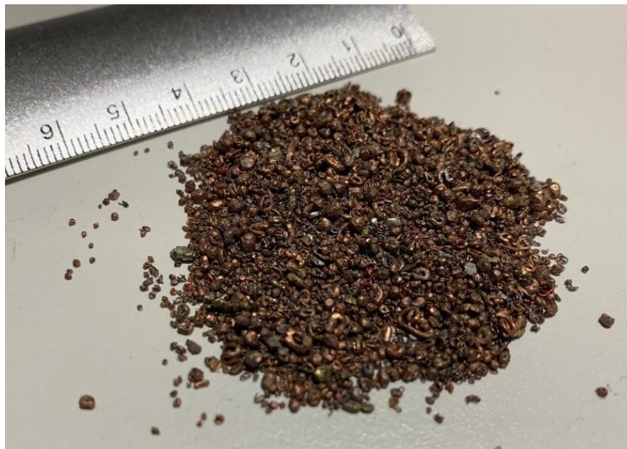
Slika 44. Granule bakra dobivene na liniji za separaciju
