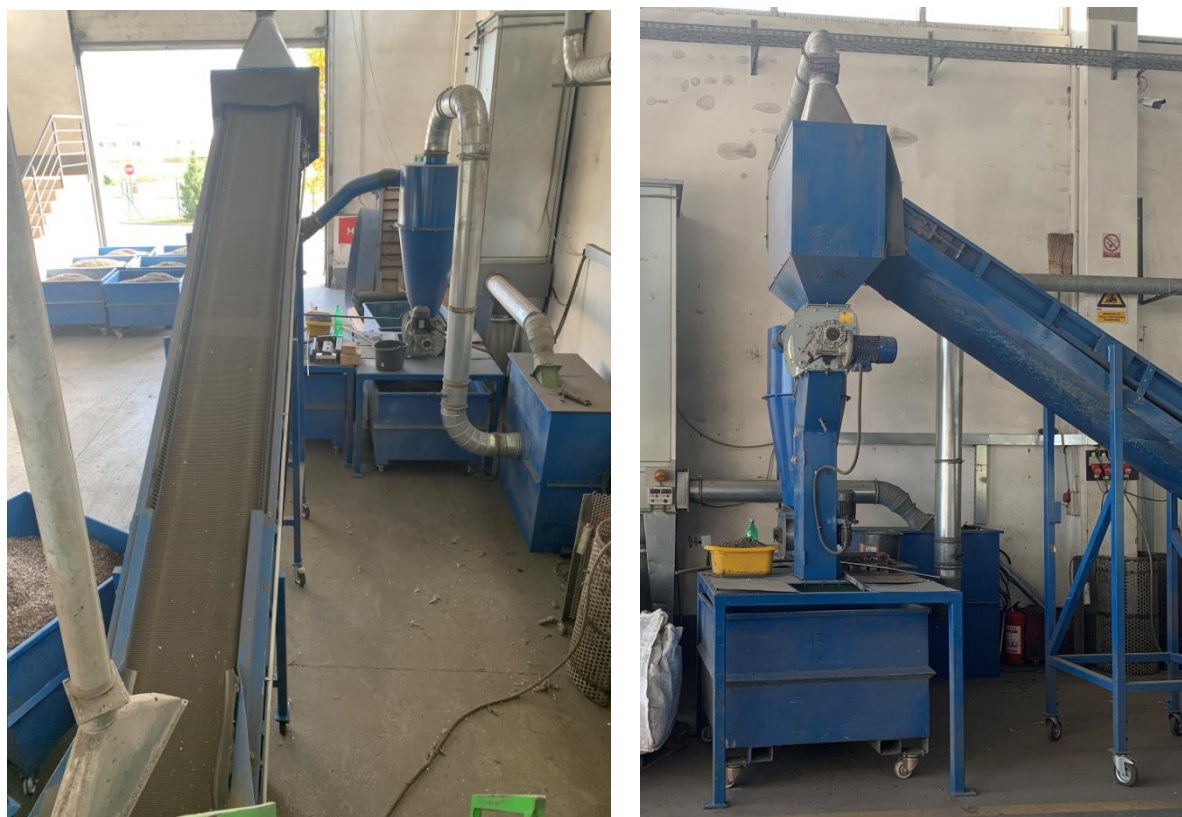
Slika 25. Kosa transportna traka, zračni separator i ciklon
