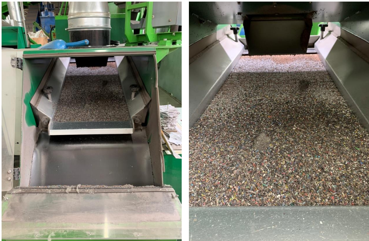
Slika 40. Zračni vibracijski separator
