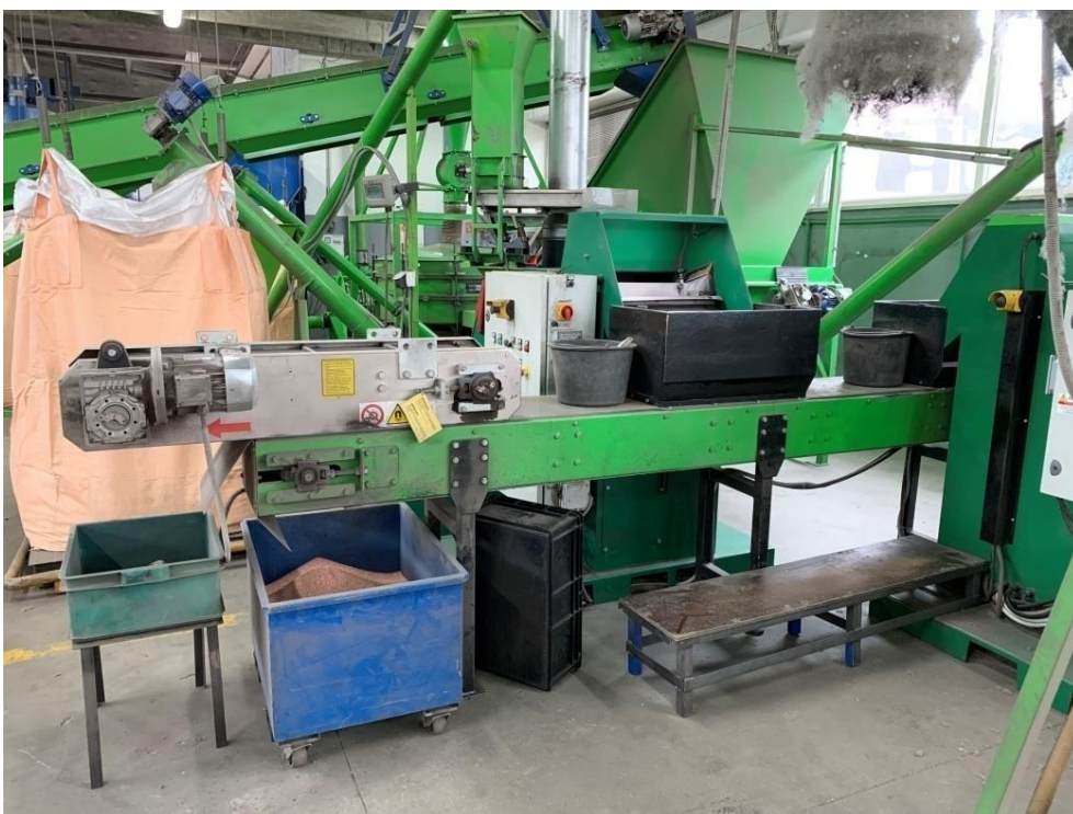
Slika 42. Pokretna traka, magnet i izlazne frakcije
