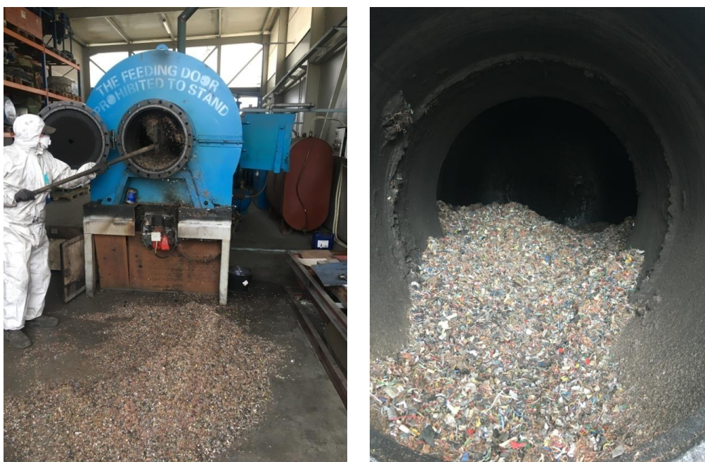
Slika 48. Ubacivanje materijala u reaktor
