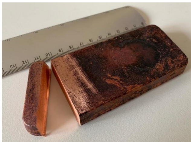
Slika 55. Odljevak pirolitičkog bakra
