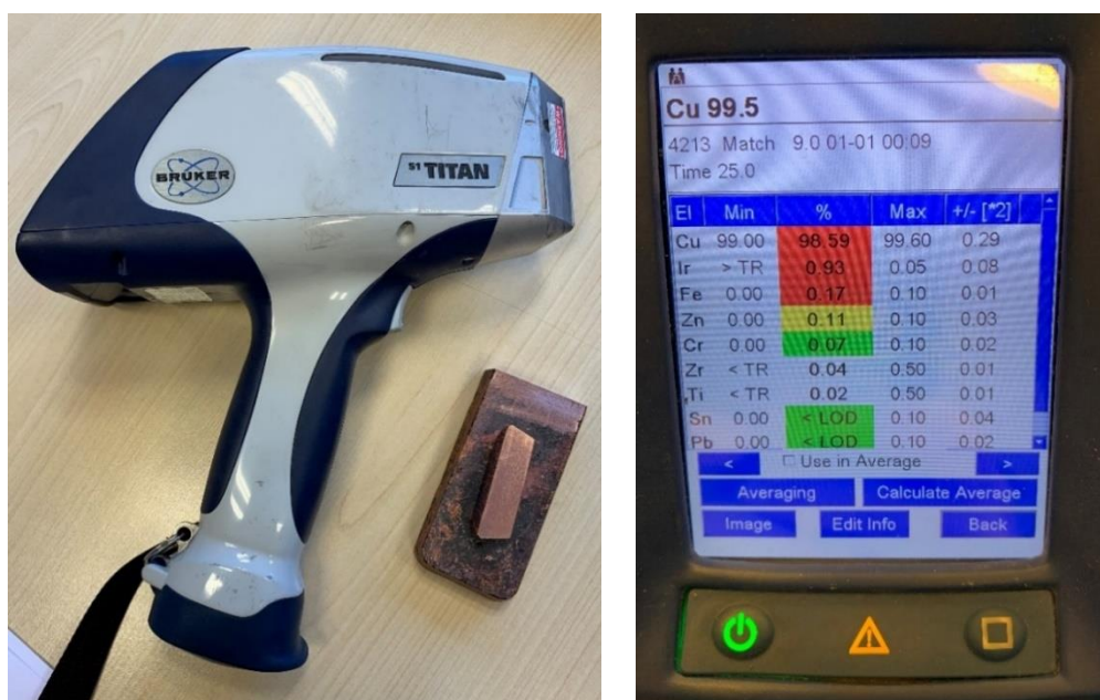
Slika 56. Ručni XRF spektrometar i dobivena analiza
