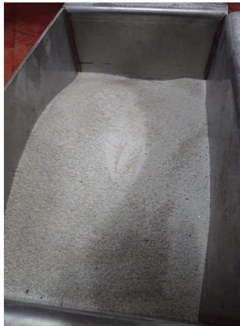
**Slika 42. Kvarcni pijesak ( $\text{SiO}_2$ )**
