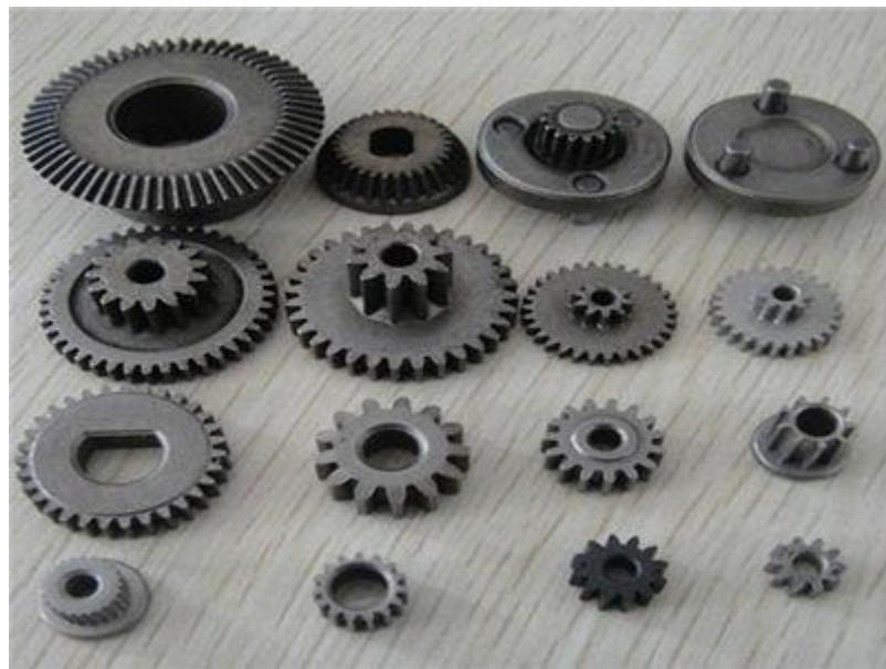
Slika 17. Primjena metalurgije praha [17]
