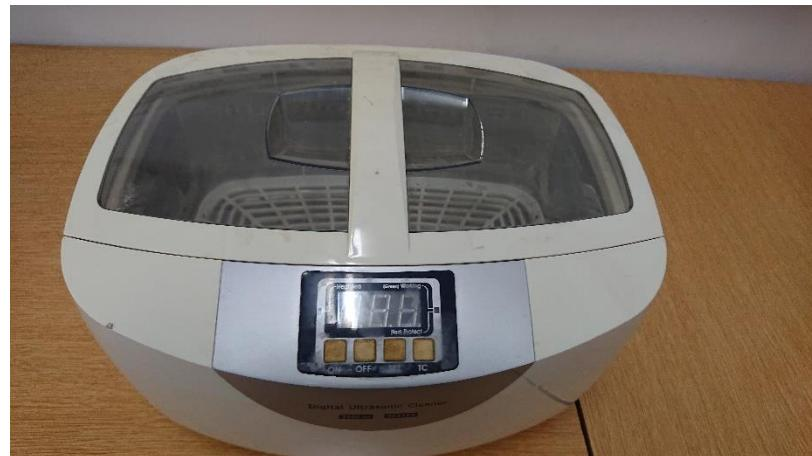
**Slika 38. Ultrazvučna kupka za čišćenje uzorka**
