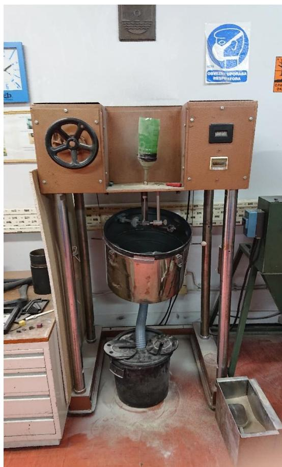
Slika 37. Uredaj za ispitivanje otpornosti na erozijsko trošenje
