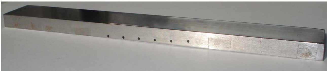
Slika 2.3. Izrađeni etalon Test Bar
