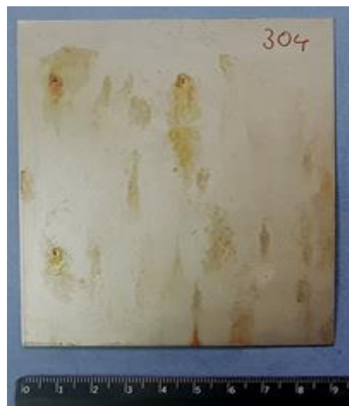
Nakon uklanjanja korozivnih produkata
