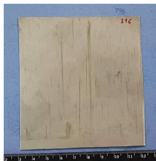
Nakon uklanjanja korozivnih produkata
