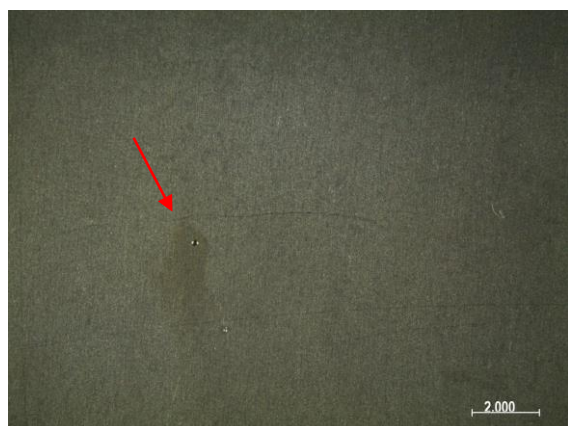
katodno šticeći uzorak u 3,5 % otopini NaCl s dodatkom H 2 O 2
