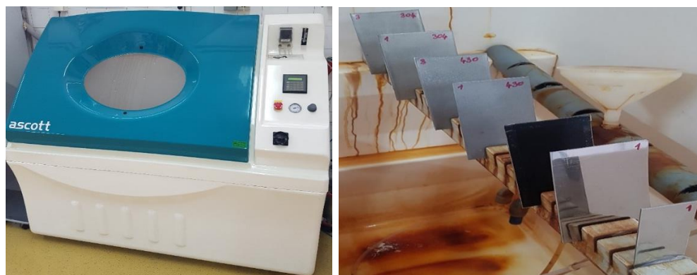
Slika 36. Ispitivanje uzoraka u slanoj komori
