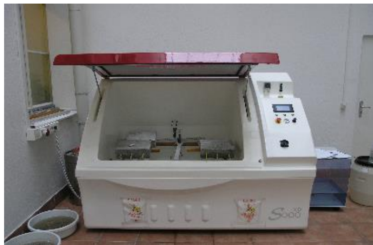
Slika 22. Slana komora za ubrzano korozijsko ispitivanje [21]
