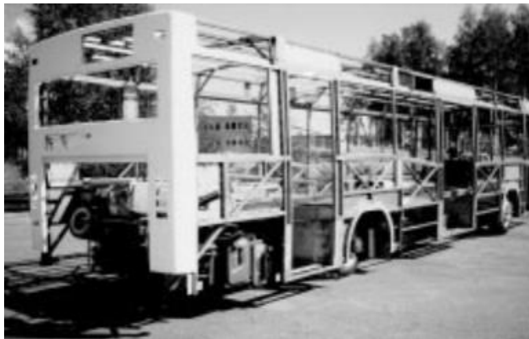
Slika 20. Karoserija autobusa od nehrđajućeg čelika [12]
