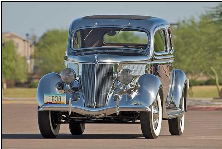
Slika 11. Fordov model iz 1936. izrađen od nehrđajućeg čelika [9]
