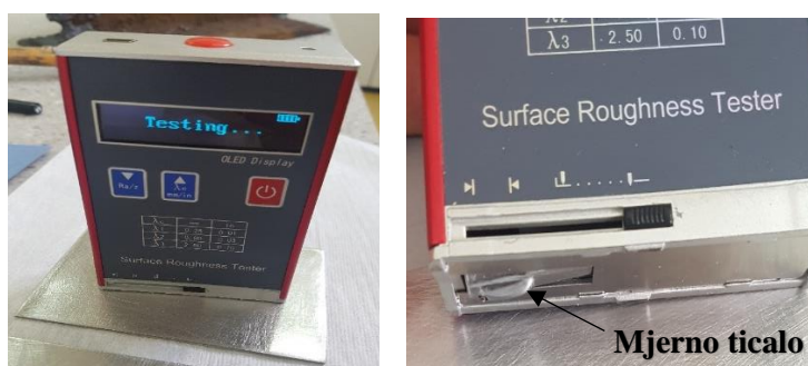
Slika 30. Mjerni uređaj za ispitivanje hrapavosti
