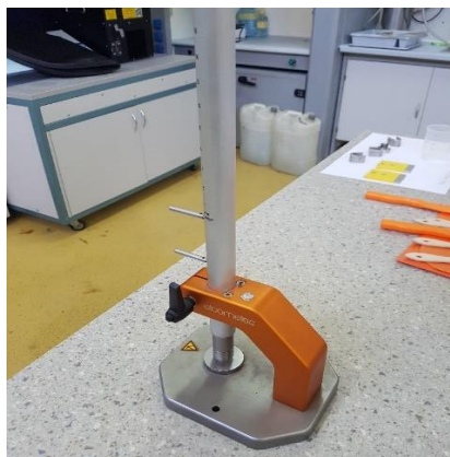
Slika 41. Uređaj za ispitivanje otpornosti na udar
