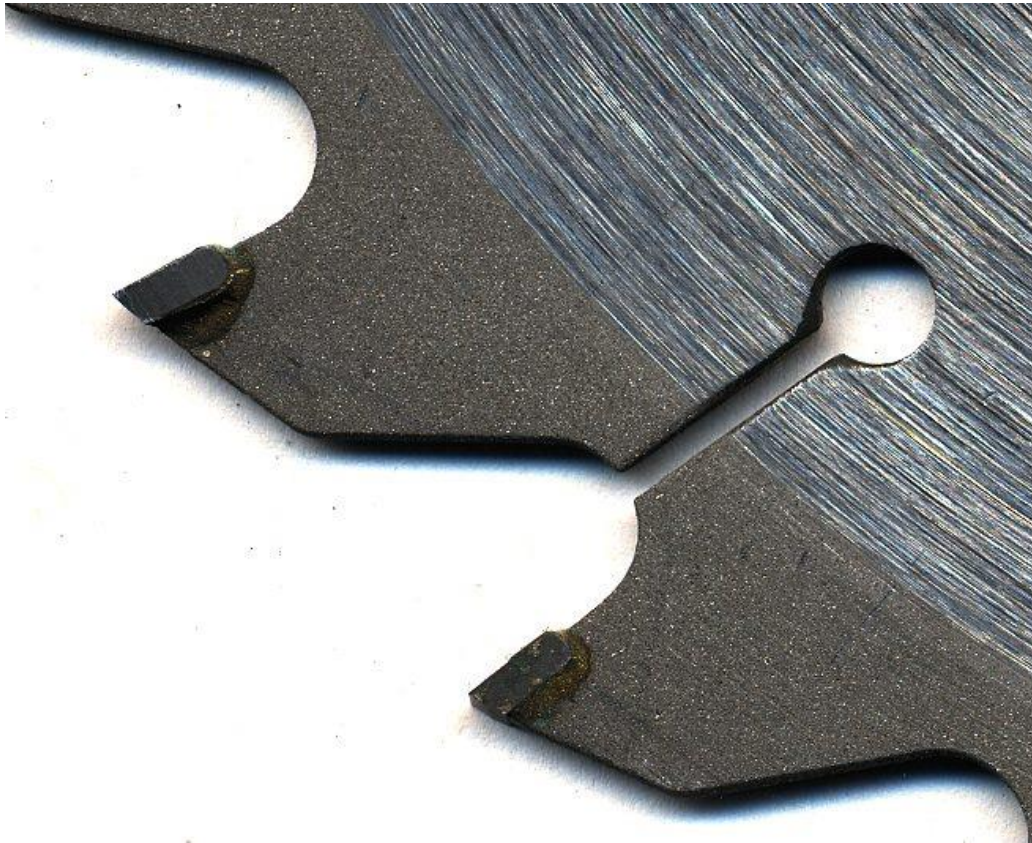
Slika 3.5. Rezne pločice pile za rezanje [19]
