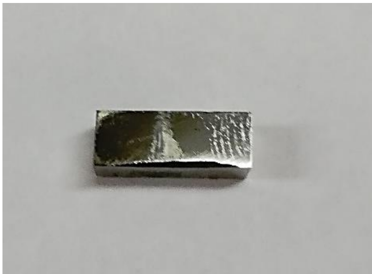
Slika 6.2. Izrezani uzorak WC-15Co
