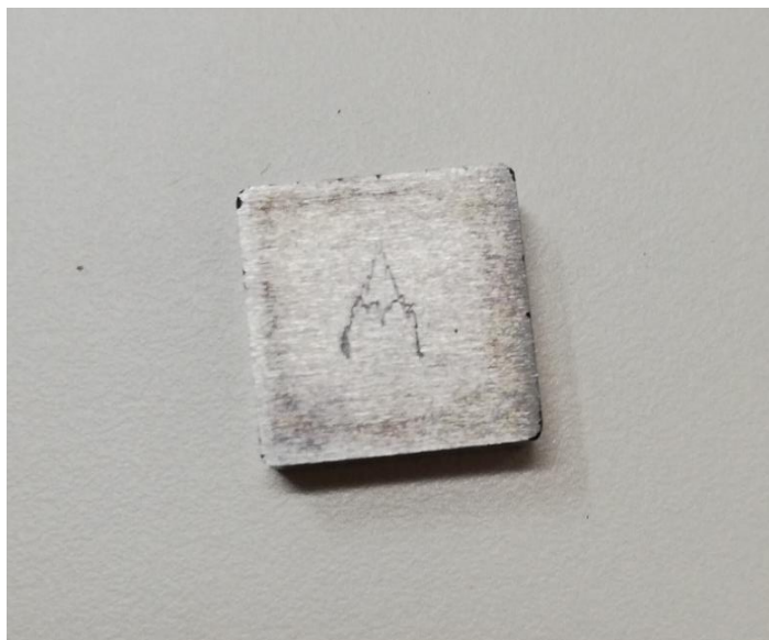
Slika 6.1. Uzorak tvrdog metala s 5 % kobalta
