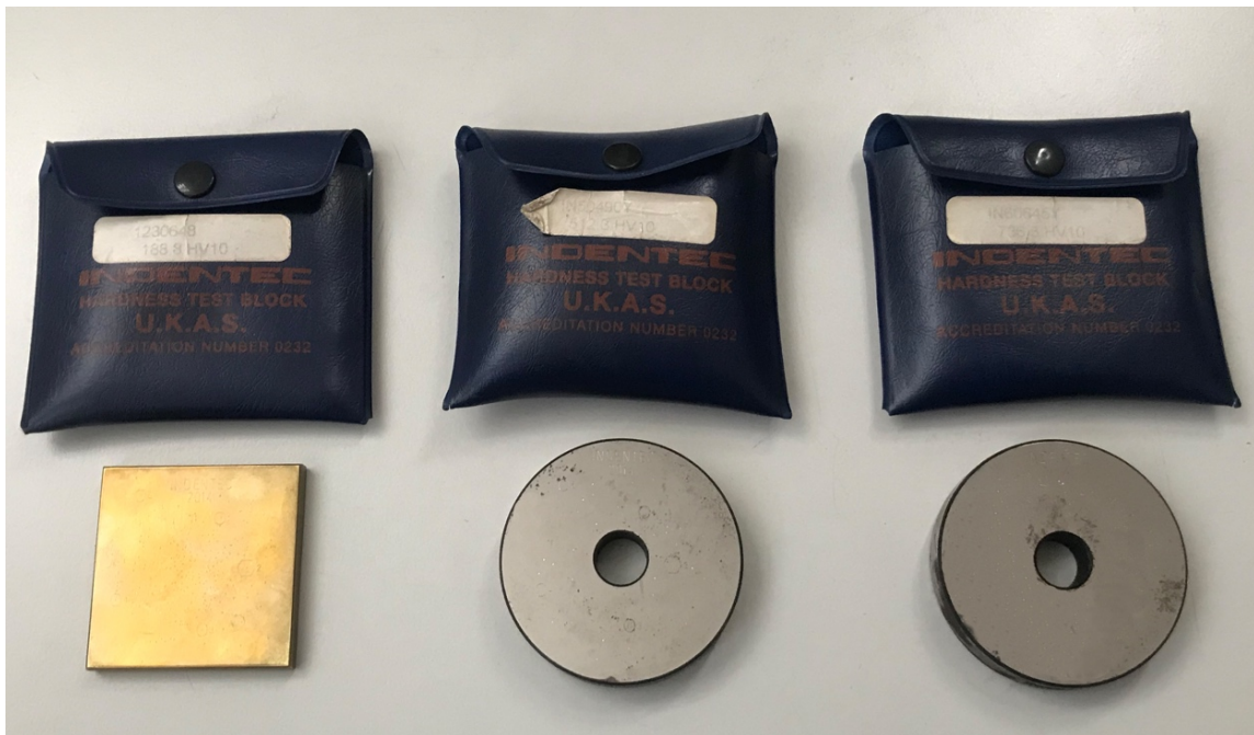
Slika 13. Primarne etalonske pločice: 188,8 HV 10; 512,3 HV 10; 736,3 HV 10
