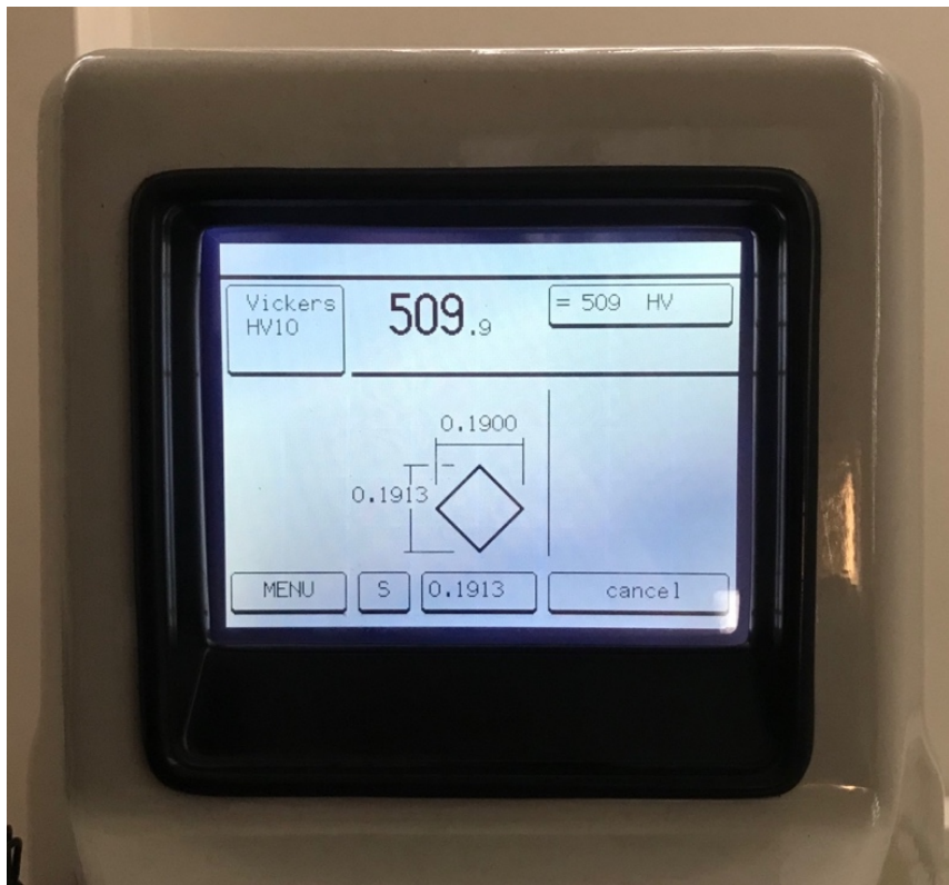
Slika 12. Zaslom tvrdomjera na kojem su prikazani rezultati mjerenja
