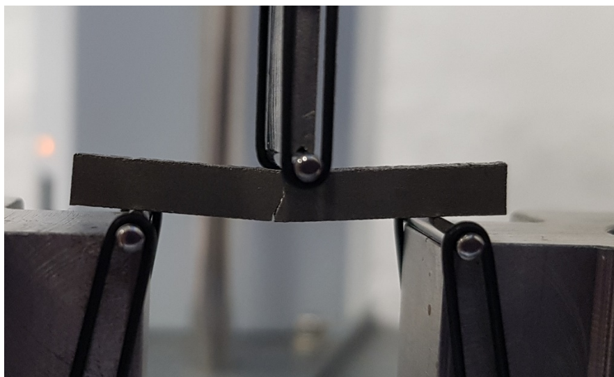
Slika 58. Izgled loma šuplje epruvete
