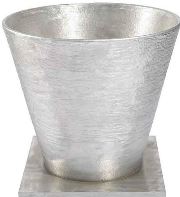
Slika 22 Stožac promjera 0,8 m izrađen WAAM tehnologijom [32]
