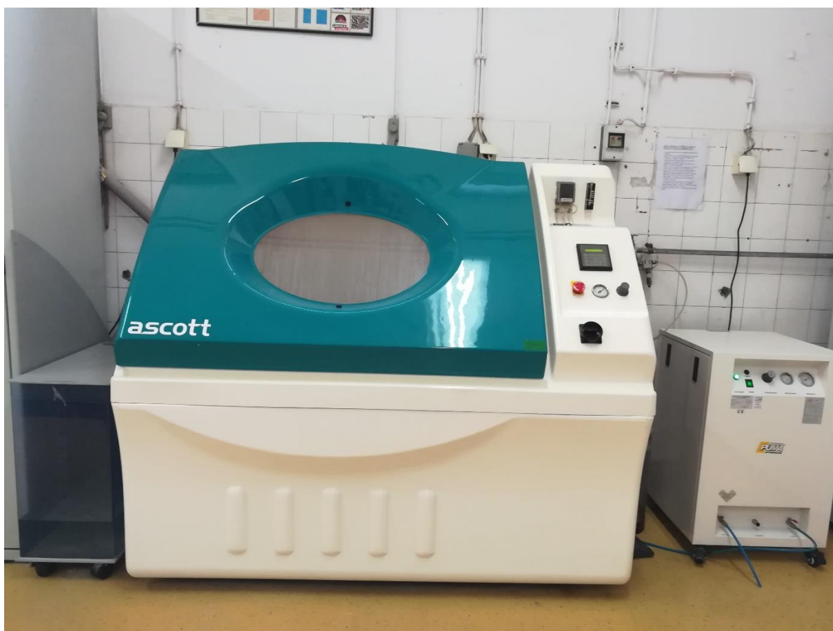
Slika 59 Ispitivanje u slanoj komori tipa Ascott S450
