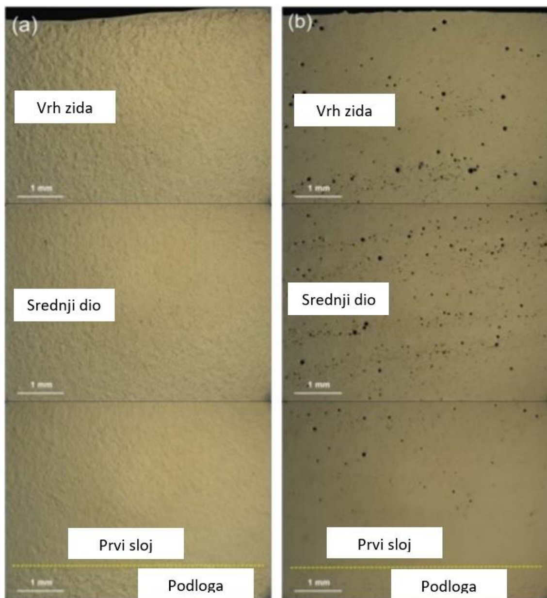
Slika 20 Primjer poroznosti kod aluminijske legure 2319 taložene različitim varijantama MIG postupka [40]
