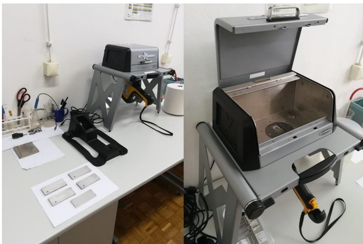
Slika 30 Prikaz XRF analizatora za ispitivanje kemijskog sastava
