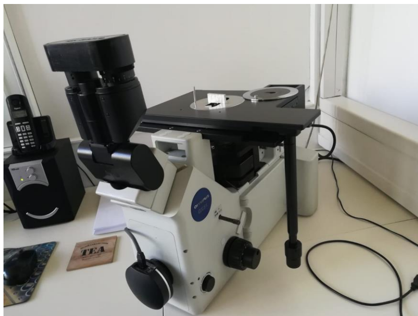
Slika 37 Svjetlosni mikroskop Olympus GX51, Laboratorij za materijalografiju, FSB
