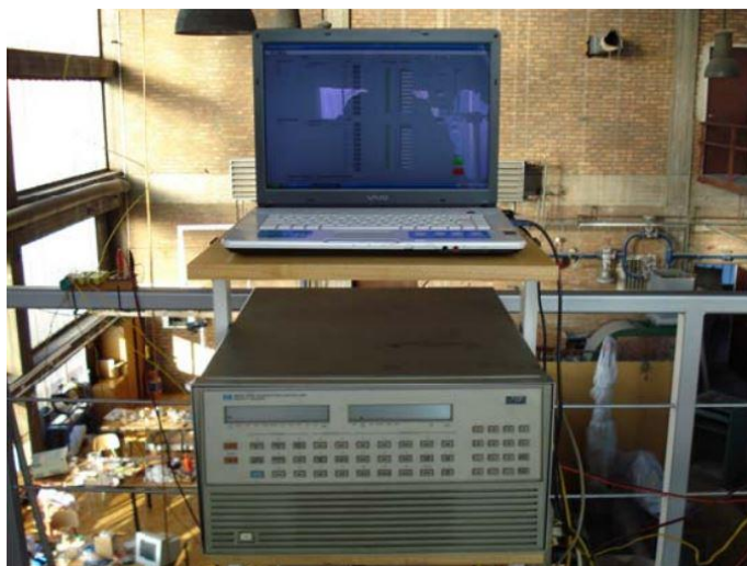
Slika 17. Mjerna centrala (dolje) s povezanim računalom (gore) [3]
