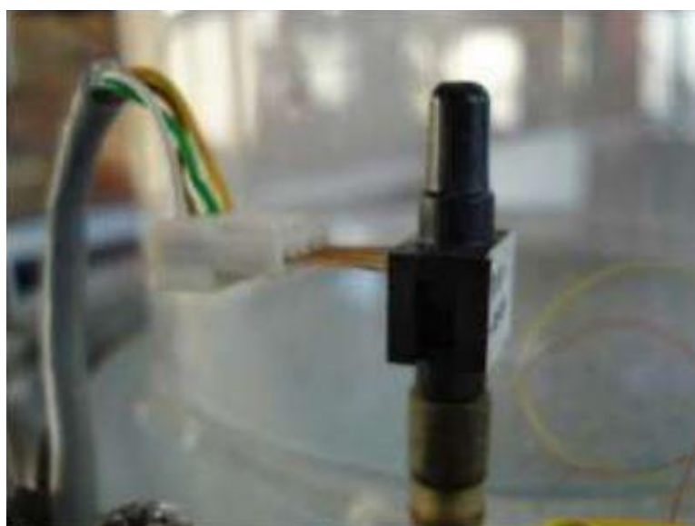
Slika 15. Osjetnik diferencijalnog tlaka PX26 – 001DV [3]
