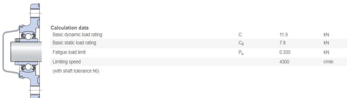
Slika 14. Prikaz ležaja i parametara za kontrolni proračun [9]
