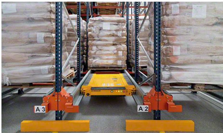
Slika 16. Radio Shuttle unutar staze u regalnom sustavu [9]
