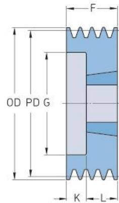
Slika 40. Dimenzije pogonske remenice [27]
