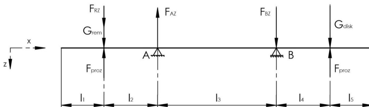
Slika 51. Opterećenje gonjenog vratila u vertikalnoj ravnini
