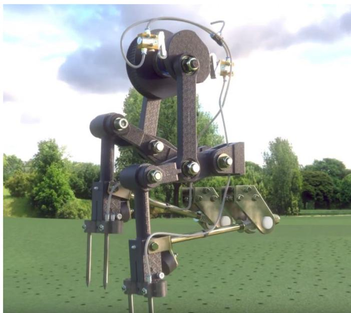
Slika 27. Transformacija rotacijskog gibanja u linearno – SISIS [23]
