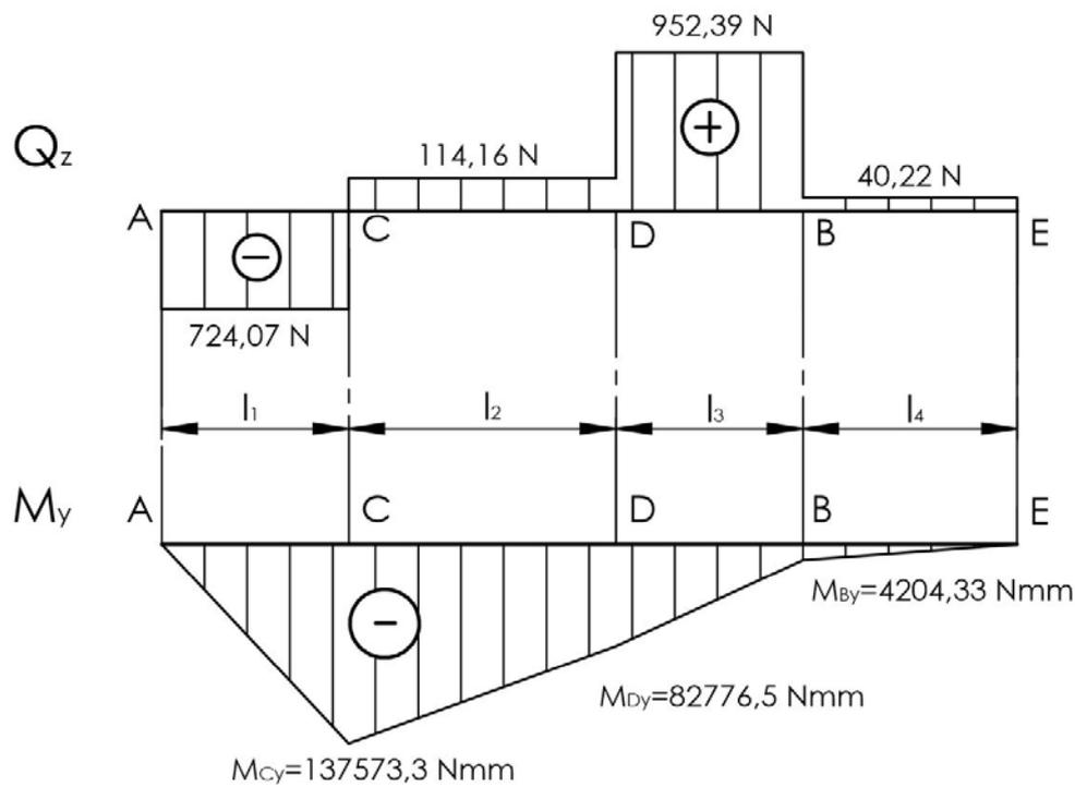
**Slika 45. Q i M dijagram pogonskog vratila u vertikalnoj ravnini**
