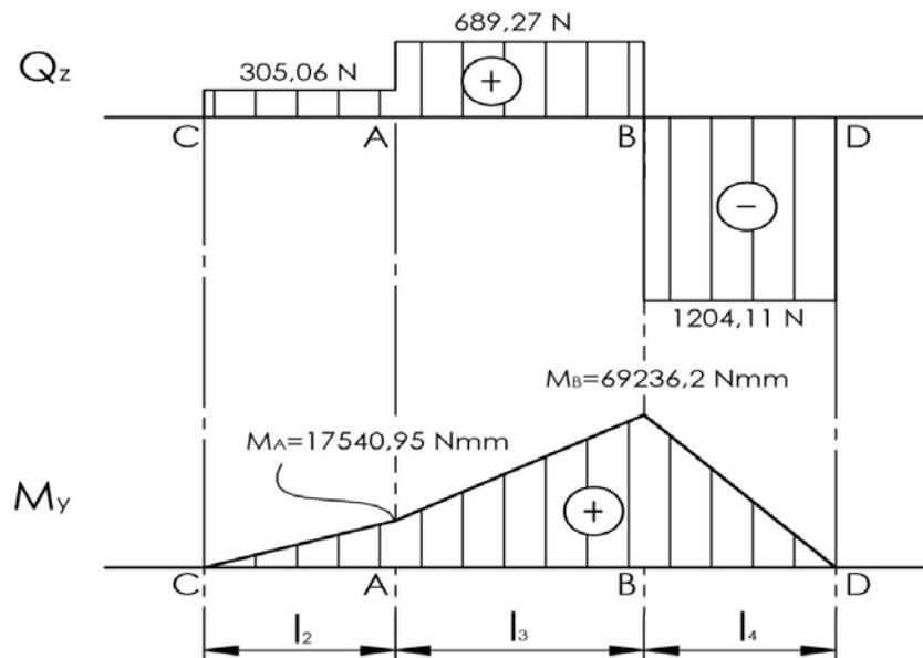
Slika 52. Q i M dijagram gonjenog vratila u vertikalnoj ravnini
