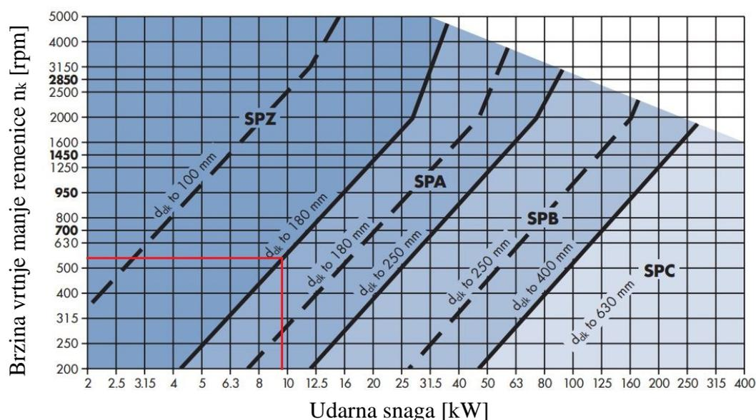
**Slika 39. Izbor profila remena i promjera pogonske remenice [26]**
