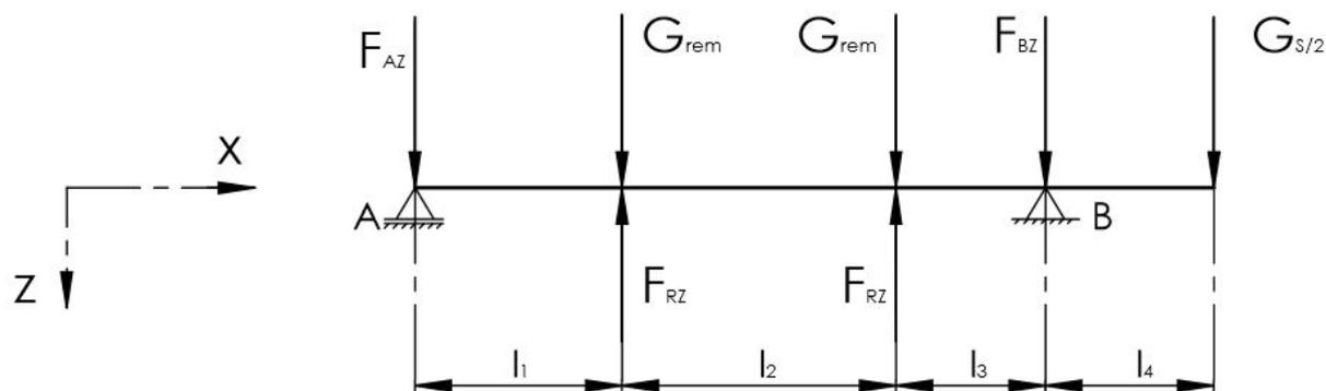
**Slika 44. Opterećenje pogonskog vratila u vertikalnoj ravnini**
