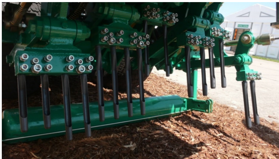
Slika 19. Glava sa zubima prozračivača AEROKING 300.80 [20]
