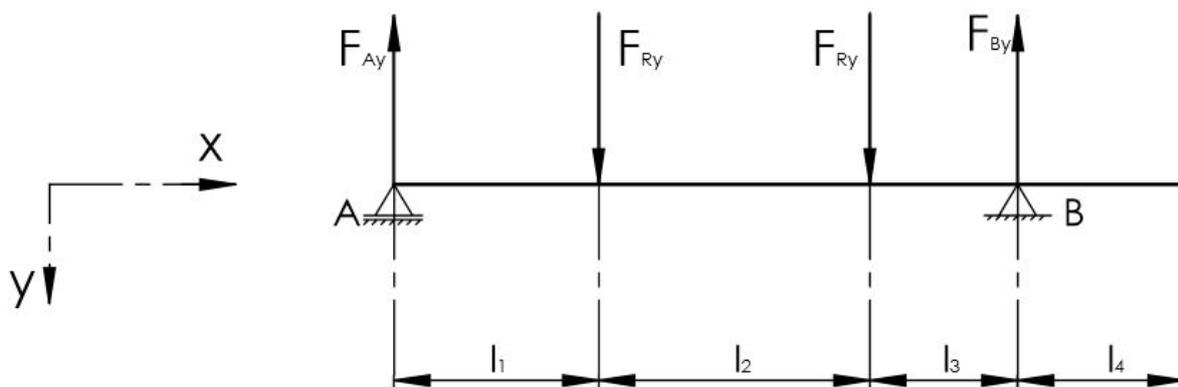
**Slika 46. Opterećenje pogonskog vratila u horizontalnoj ravnini**
