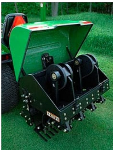
Slika 24. Transformacija rotacijskog gibanja u linearno – John Deere [22]
