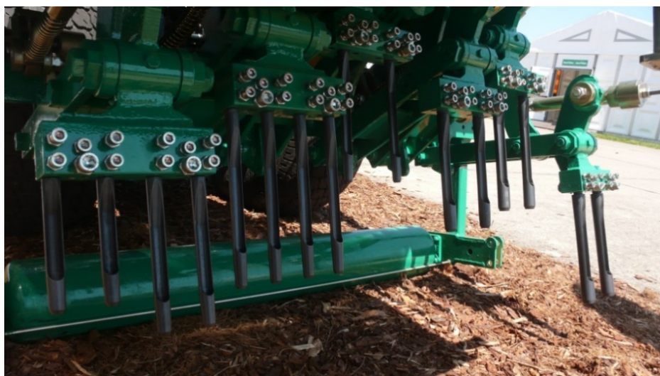
Slika 19. Glava sa zubima prozračivača AEROKING 300.80 [20]
