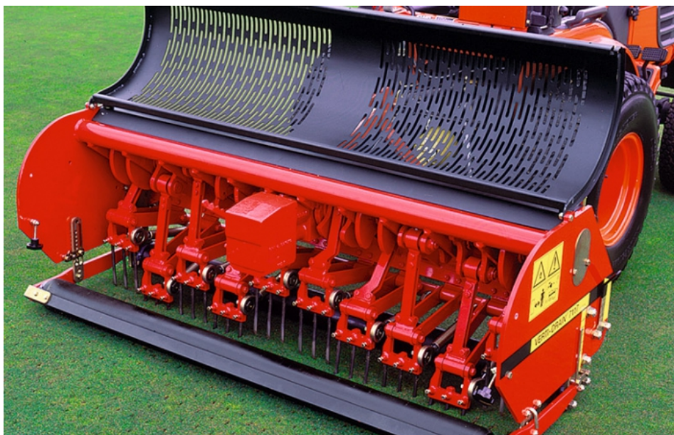
Slika 17. Unutrašnjost prozračivača Verti-Drain 2220 [19]
