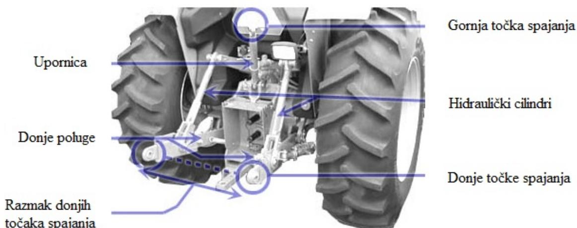
Slika 4. Traktorski priključak u 3 točke [9]
