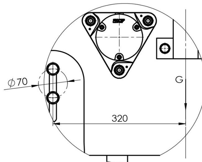
Slika 72. Opterećenje vijaka nosivog sklopa
