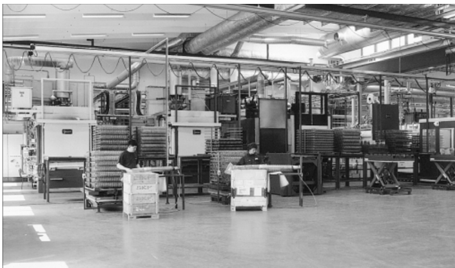
Slika 3. Linijski poredane peći u postupku COLOURNITE® [10]
