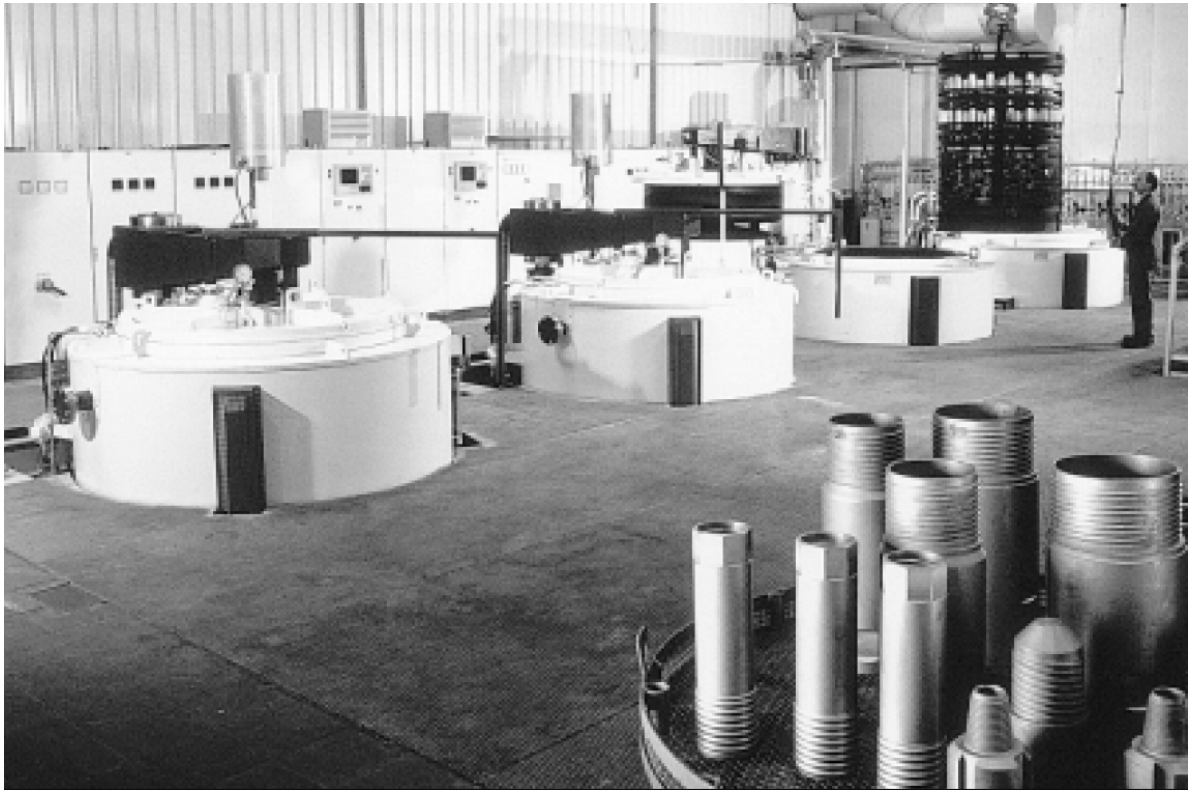
Slika 6. Linija peći za nitriranje u plazmi plinova postupkom IONIT-OX® [11]
